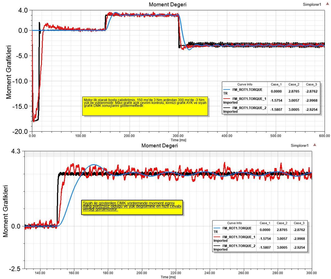
Şekil 5.19: a) AYK-DMK ve UVDGM yöntemi ile sürülen SMSM'nin moment-zaman grafikleri b) Yakınlaştırılmış moment-zaman grafiği
