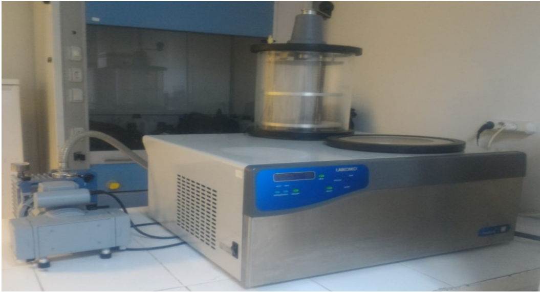
Şekil 2.4: Liyofilizatör cihazı (Çözelti veya süspansiyon halindeki ürünün dondurulması ve sonrasında süblimasyon ile oluşan gaz fazının uzaklaştırılması sonucu maddenin kurutulmasını sağlayan bir süreçtir)
