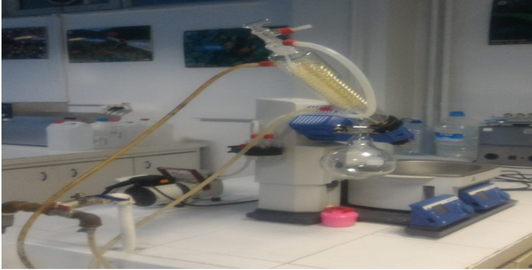
Şekil 2.3: Rotary evaporatör (Döner bir buharlaştırıcı, kimyasal laboratuarlarda çözücülerin numunelerden buharlaştırma yoluyla etkili ve yumuşak bir şekilde çıkarılması için kullanılan bir cihazdır.)
