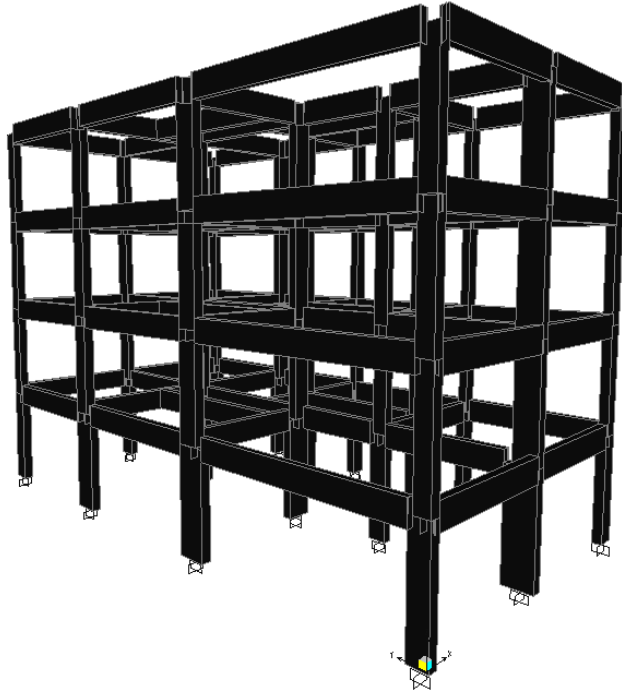
Şekil 4.9: Kapasite eğrisi verilen binanın SAP2000 programında oluşturulan taşıyıcı sistem modeli
