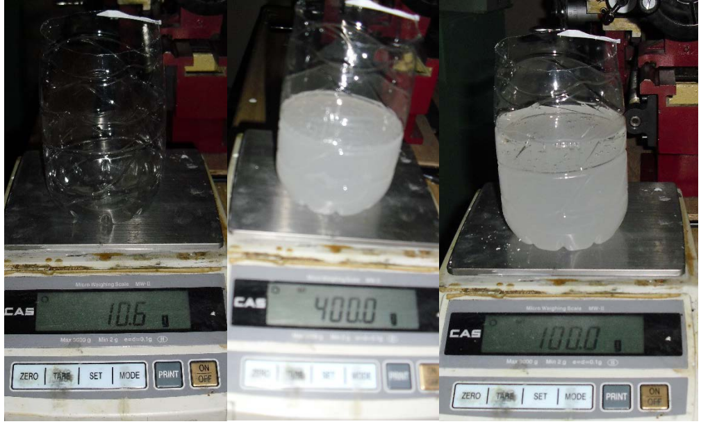
Şekil 3.6 Epoksi Reçine dozajlama işlem adımları örneği
