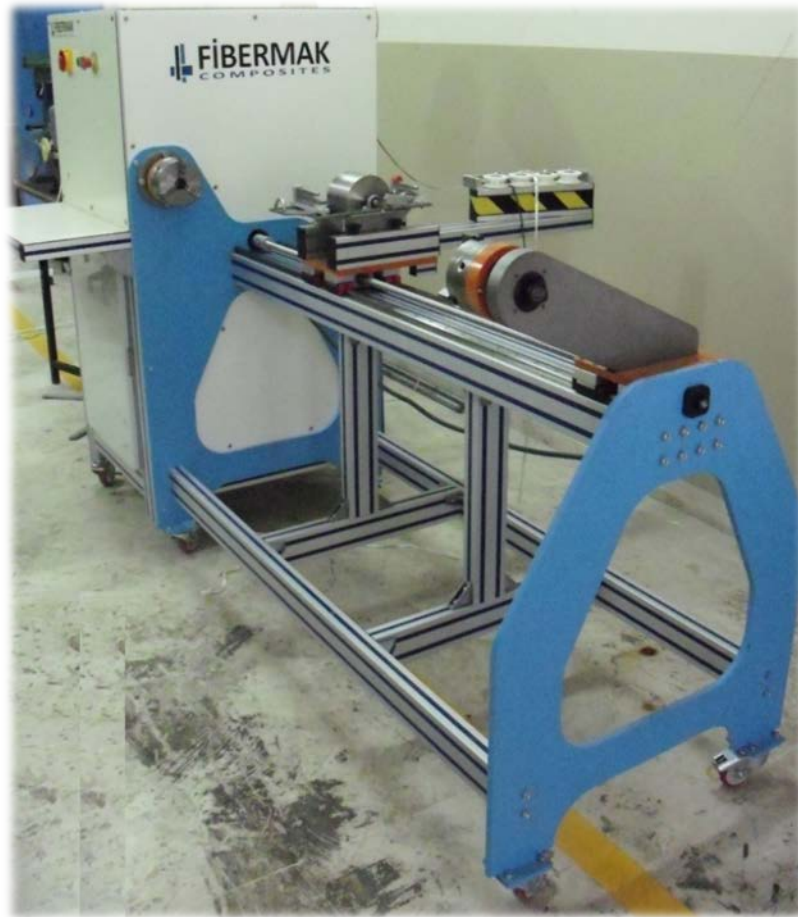
Şekil 3.5 CNC elyaf sarma makinası
