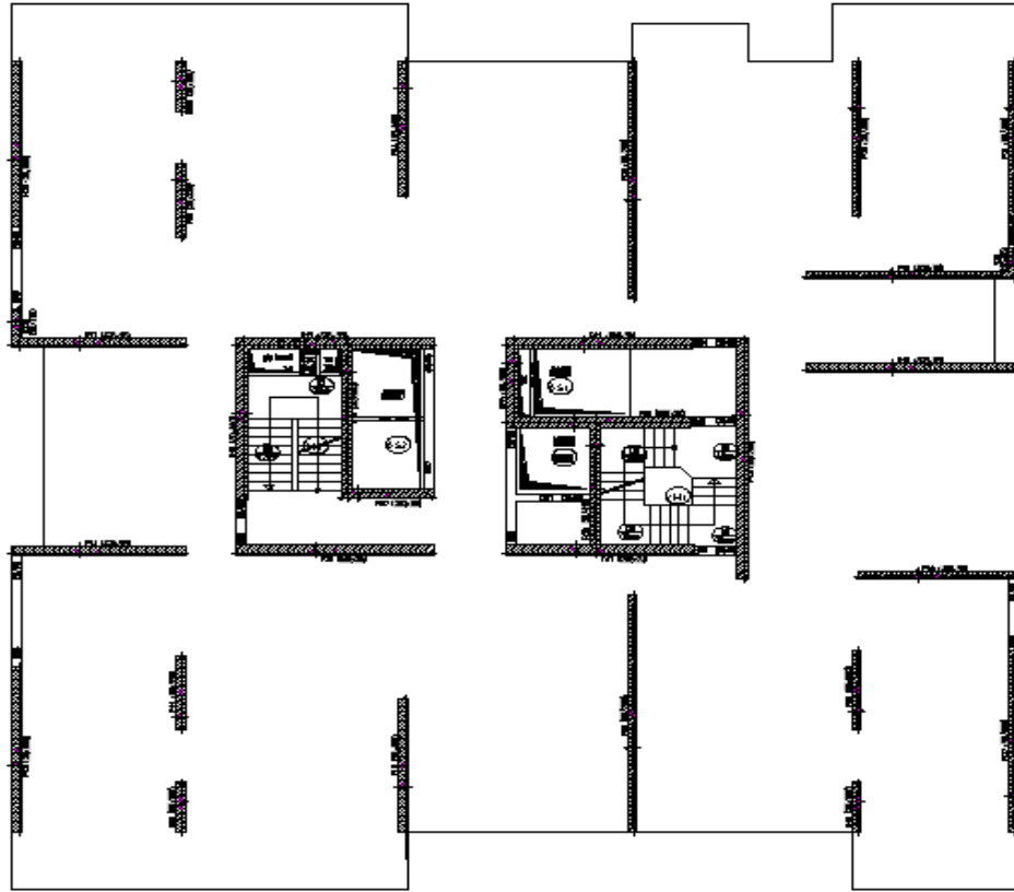
Şekil 3.27: 09 Nolu Binaya Ait Kalıp Planı
