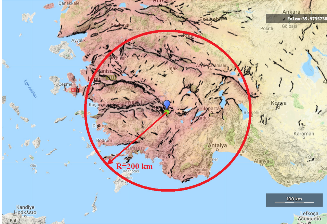
Şekil 8.7: OSTA için seçilen Denizli/Merkez noktası ve R=200 km alanda bulunan diri faylar
