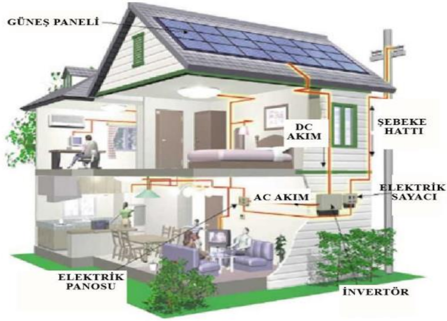
b) ON-GRİD (Şebekeye Bağımlı Fotovoltaik Sistem) (Url-16)
