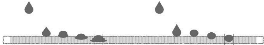
Şekil 2.13: Basılan boya damlasının ön işlemsiz(solda)ön işlemli difüzyonu
