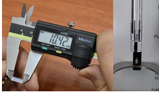
Şekil 3.46: Isıl genleşme test numunesinin boyutlarının ölçülmesi ve cihaza yerleştirilmesi
