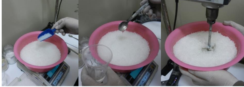
Şekil 3.9: Granül-polidimetil siloksanın karışım işlemi
