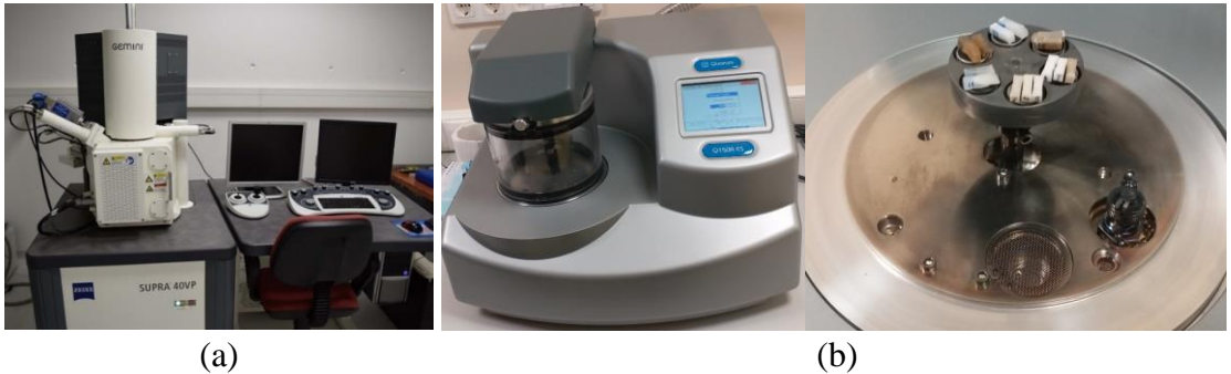
Şekil 3.30: (a) ZEISS Supra 40VP alan SEM cihazı ve (b) Quorum marka Q150R ES model SEM/TEM kaplama cihazı
