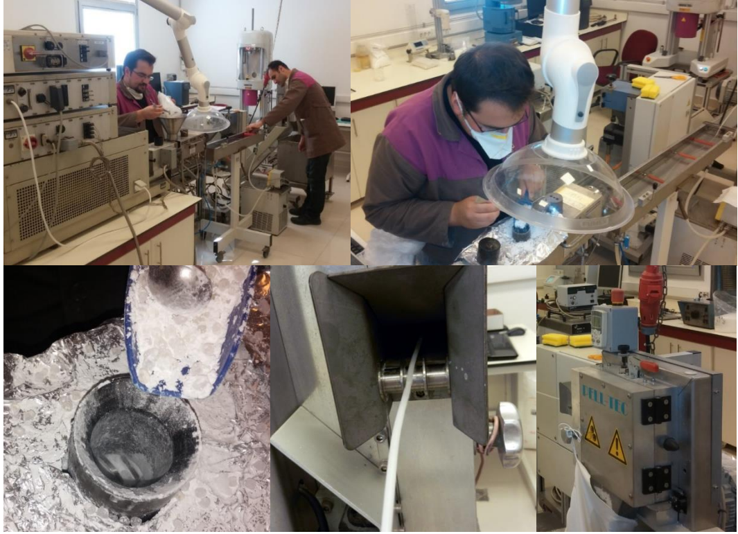
Şekil 3.17: Granül-toz malzeme karışımının ekstrüderde karıştırılması
