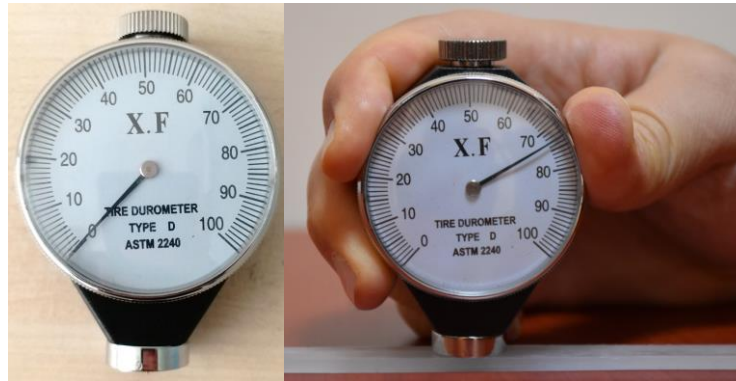
Şekil 3.23: X.F Shore D sertlik ölçüm cihazı ve ölçüm alma
