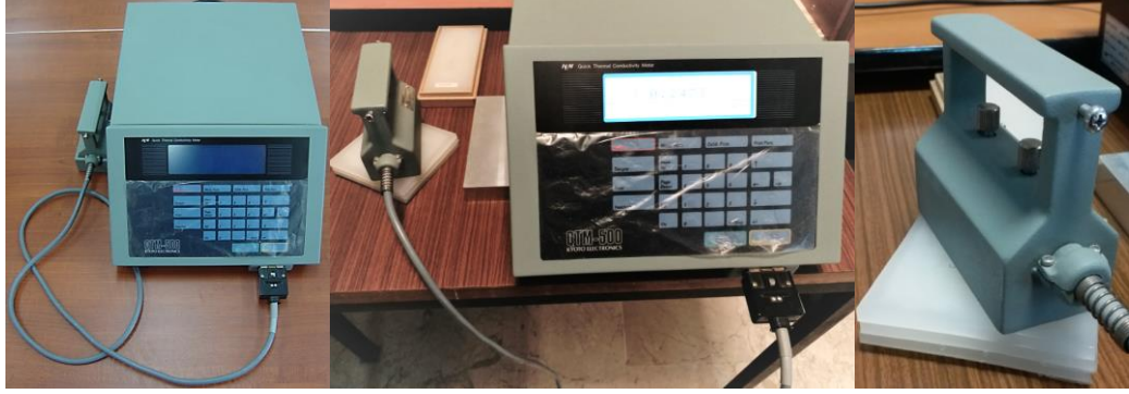
Şekil 3.47: Kyoto Electronics (QTM-500) model ısıl iletkenlik ölçüm cihazı
