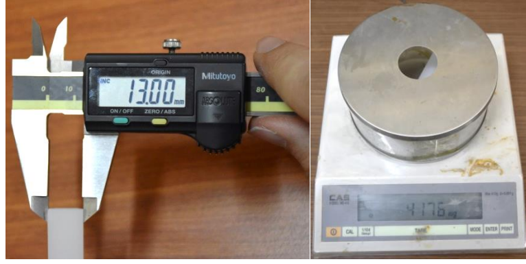
Şekil 3.21: Numune boyutlarının ölçülmesi ve tartılması
