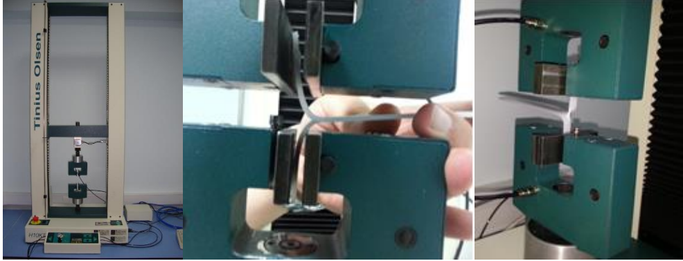
Şekil 3.42: Tinius Olsen H10KT üniversal test cihazı ve yırtılma numunesinin çenelere bağlanması
