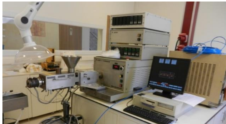
Şekil 3.8: Brabender Plasti-Corder PL2000 çift vidalı ekstrüder
