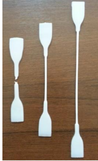
Şekil 3.33: Farklı çekme hızlarında numunelerde oluşan deformasyonlar
