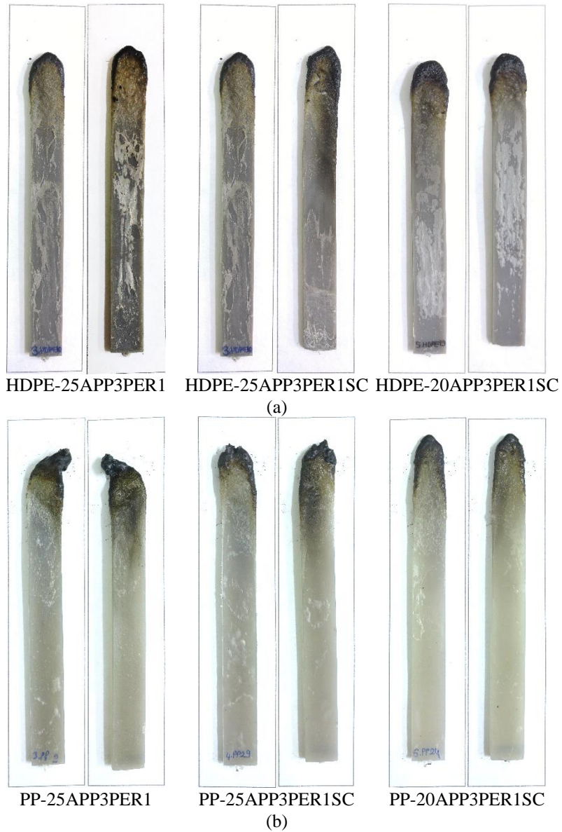
Şekil 4.143: (a) HDPE ve (b) PP APP-PER-LH15C-1251-SC kompozitlerinin yanma sonrası görüntüleri
