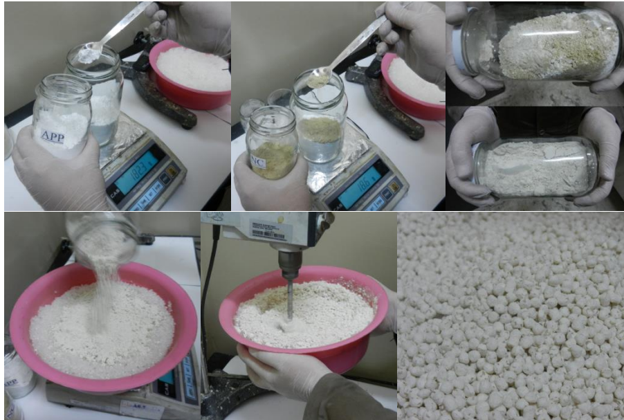
Şekil 3.10: Katkı ve dolgu maddelerinin tartımı ve karıştırılması
