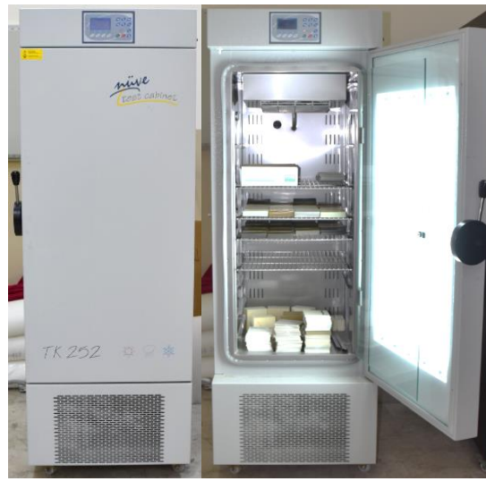
Şekil 3.20: Nüve TK 252 şartlandırıcı ünitesi
