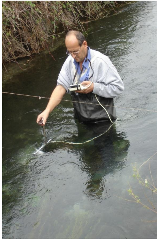
Şekil 4.2: Pınarbaşı kaynađında muline ile debi ölçümü.
