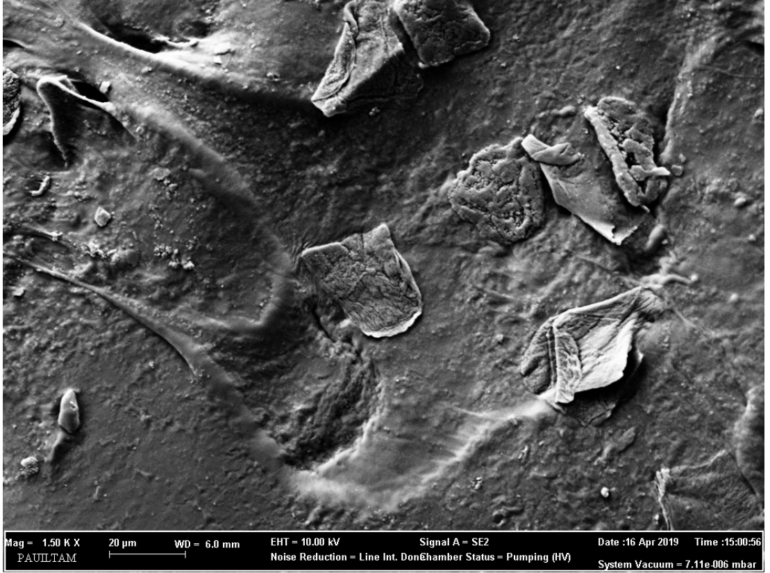
Şekil 46.474: Karbon nano tüp ile fonksiyonlaştırılmış polimer içerikli membrana ait SEM görüntüsü
