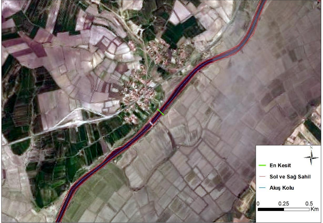
Şekil 4.21: 40 nolu ölçüm noktası için sayısallaştırılan akış kolunun, sağ ve sol sahillerin ve en kesitin HEC-GeoRAS üzerindeki görüntüsü
