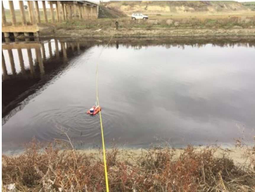
Şekil 4.13: 3 nolu ölçüm noktasında ADCP ile hız ve enkesit çıkarılması
