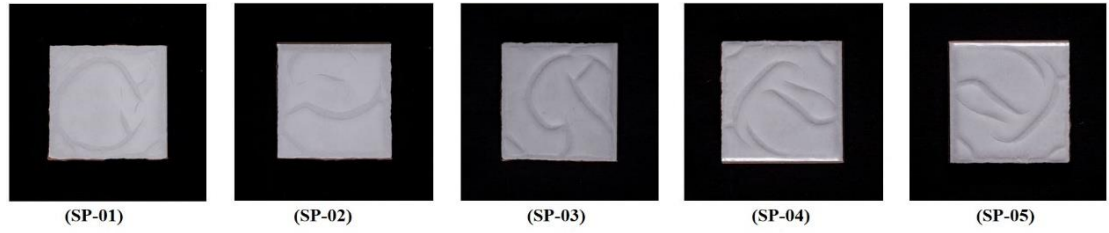
Şekil 6.8 : Sır ve PVDF-HFP solüsyonunun ısı işlem sonrası görünümü
