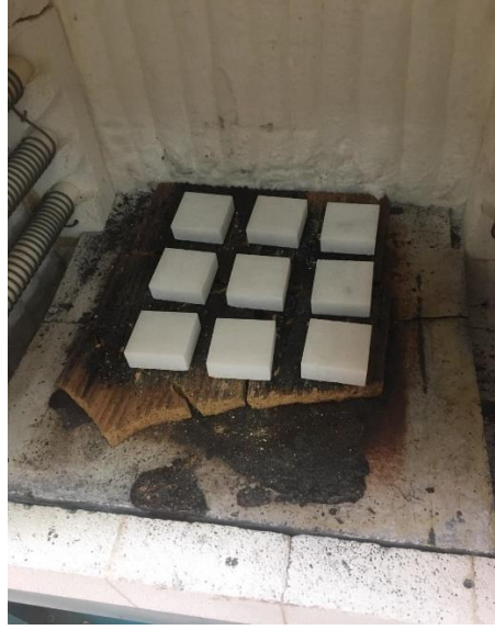
Şekil 6.4 : Oluşması muhtemel su buharının uzaklaştırılması işlemi
