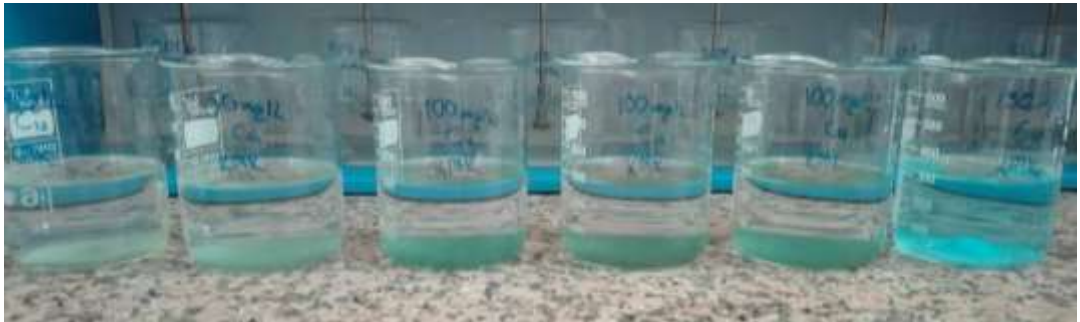
Şekil 4.57: Başlangıç Konsantrasyonunun Bakır Giderimine Etkisi Deneyi
