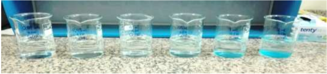
Şekil 4.45: Bakır Giderimi için \text{Ca(OH)}_2 Dozaj Deneyi
