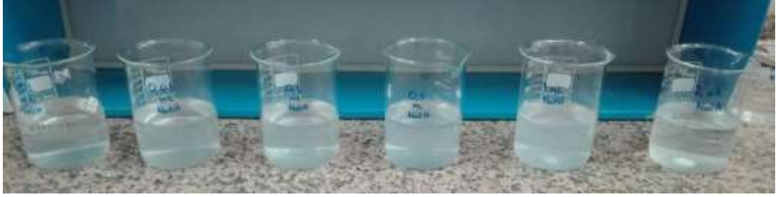
Şekil 4.5: Kurşun Giderimi İçin NaOH Dozaj Deneyi
