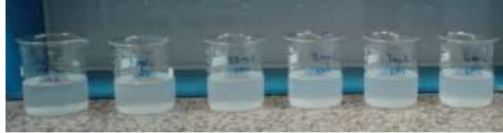
Şekil 4.1: Kurşun Giderimi için KMK Dozaj Deneyi
