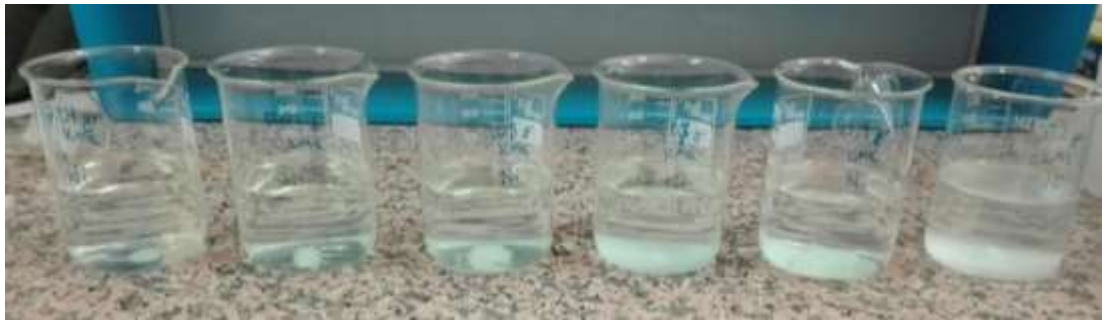
Şekil 4.17: Nikel Giderimi İçin KMK Dozaj Deneyi
