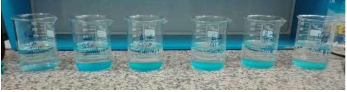
Őekil 4.49: Bakır Giderimi İçin Ca(OH) 2 Dozaj Deneyi
