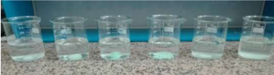
Şekil 4.29: Başlangıç Konsantrasyonunun Nikel Giderimine Etkisi Deneyi
