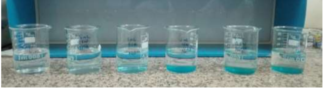
Şekil 4.41: Bakır Giderimi İçin NaOH Dozaj Deneyi
