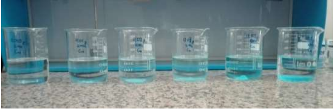
Şekil 4.33: Bakır Giderimi İçin KMK Dozaj Deneyi
