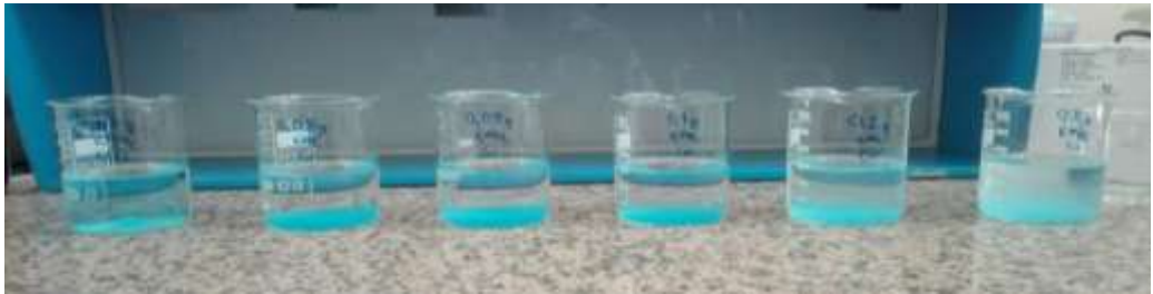
Şekil 4.37: Bakır Giderimi İçin KMK Dozajı Deneyi
