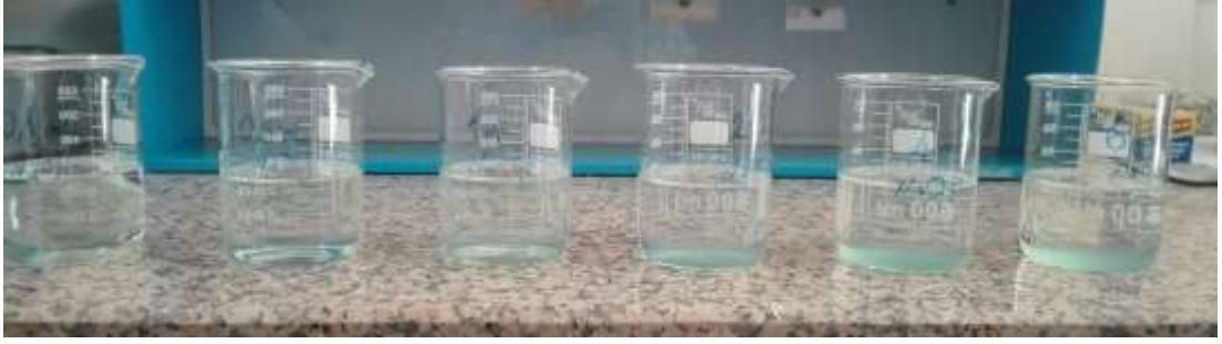
Şekil 4.21: Nikel Giderimi İçin NaOH Dozaj Deneyi
