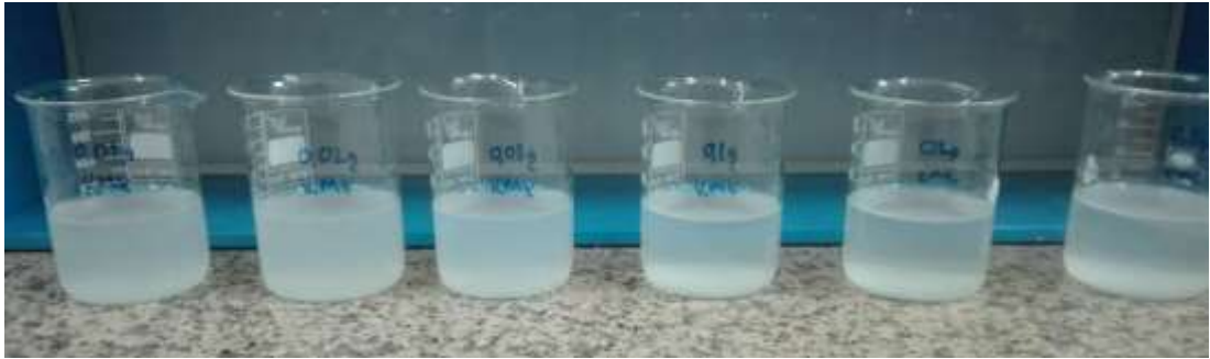
Şekil 4.9: Kurşun Giderimi İçin KMK (Katı) Dozaj Deneyi
