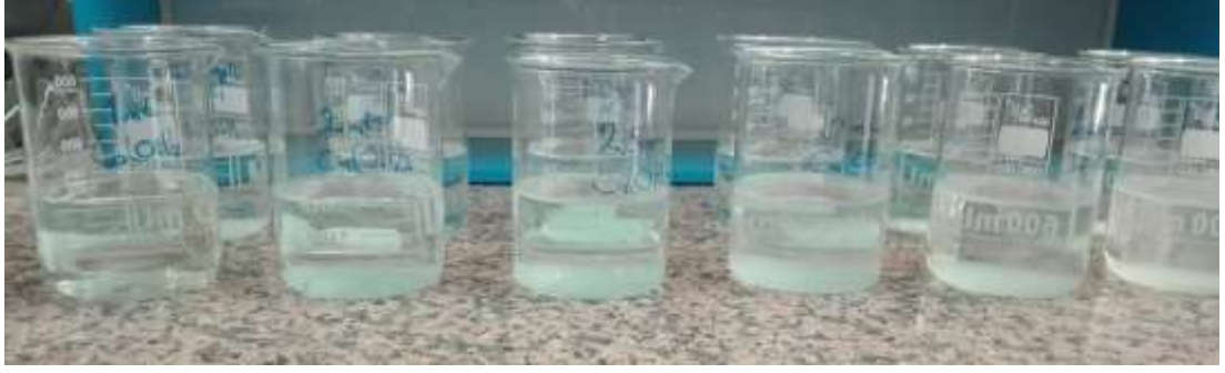
Şekil 4.25: Nikel Giderimi İçin \text{Ca}(\text{OH})_2 Dozaj Deneyi
