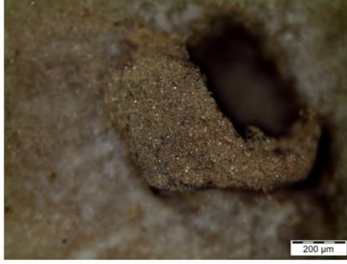
Şekil 5.7: Başaranlar mermer sahasından alınan örneklerde gözlenen pirit mineralleri.
