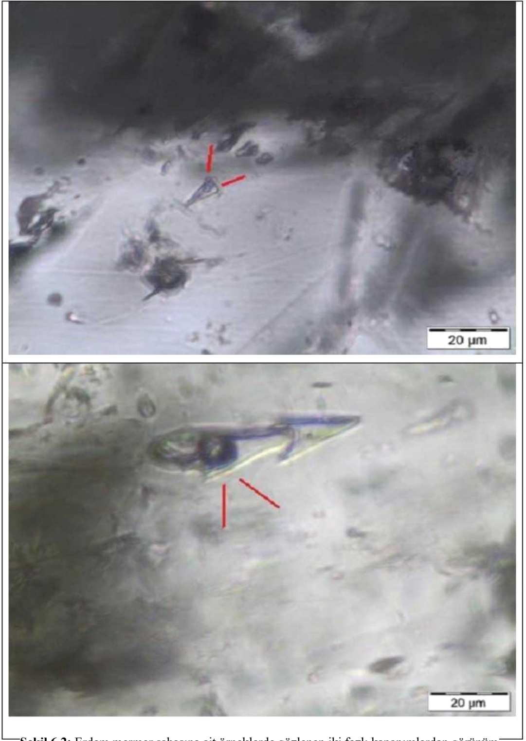
Şekil 6.2: Erdem mermer sahasına ait örneklerde gözlenen iki fazlı kapanımlardan görünüm
