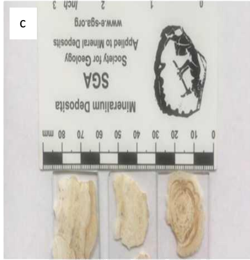
Şekil 4.3: Erdem Mermer sahasındaki travertenler ve alınan kayaç örneklerinin görünümü a-b Travertenlerin arazide görüntüsü c) hazırlanan parlak kesitlerin görüntüsü d) Travertenlerde görülen boşluklar
