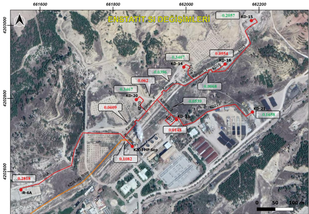
Şekil 6.6: Yüzeysel boru hatlarında karışım neticesinde Enstatit mineralinin SI değerinin değişimi.
