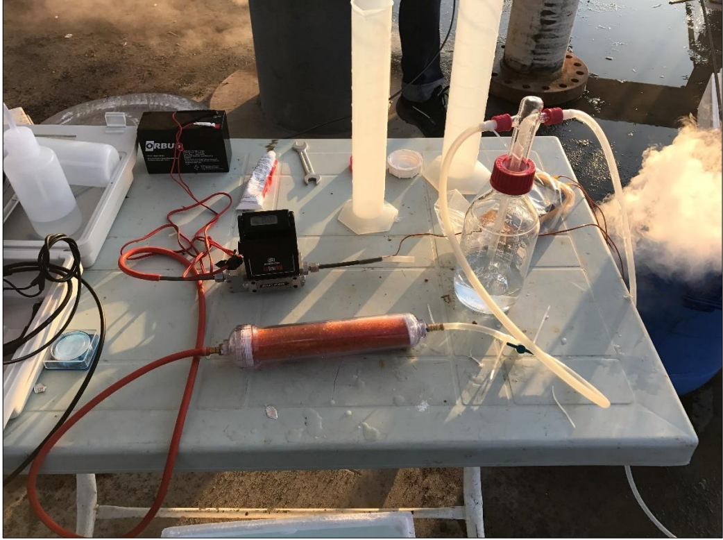
Şekil 4.5: Debi metre kullanılarak yapılan gaz/buhar oranı ölçüm düzeneği.
