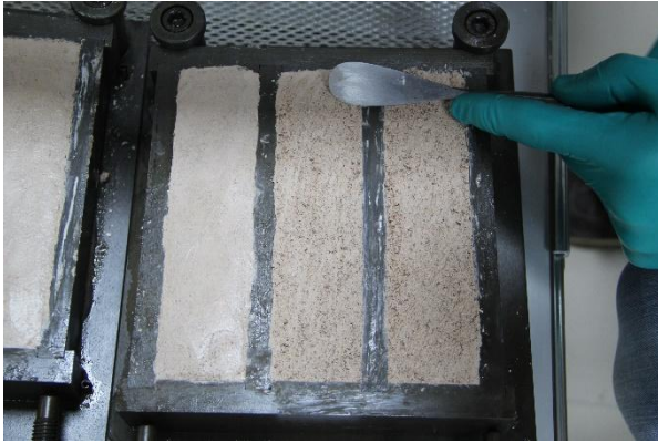
Resim 14b: Onarım Harcının Hazırlanması
