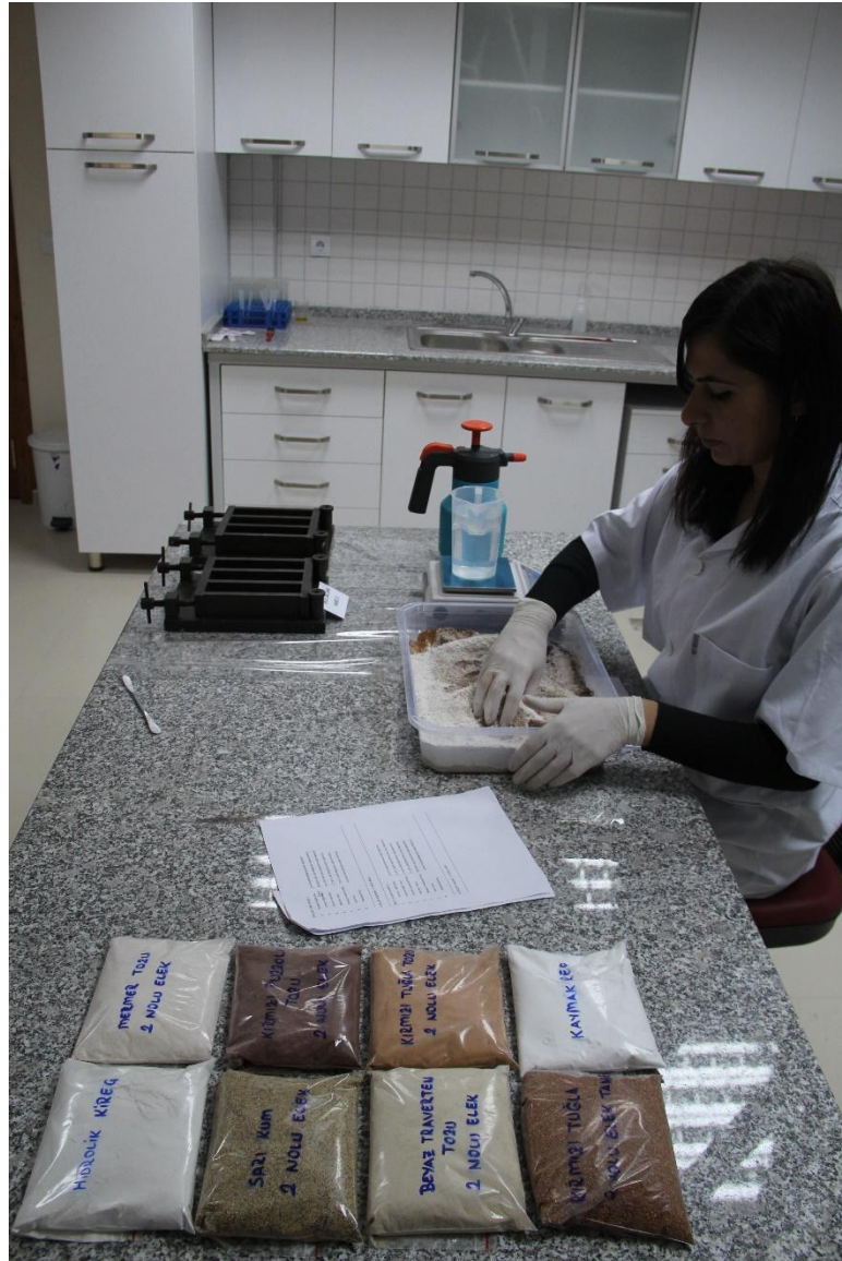
Resim 14a: Onarım Harcının Hazırlanması
