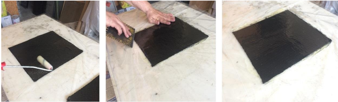
Şekil 3.4: Rulolama ve elyaf yatırma işlemi
