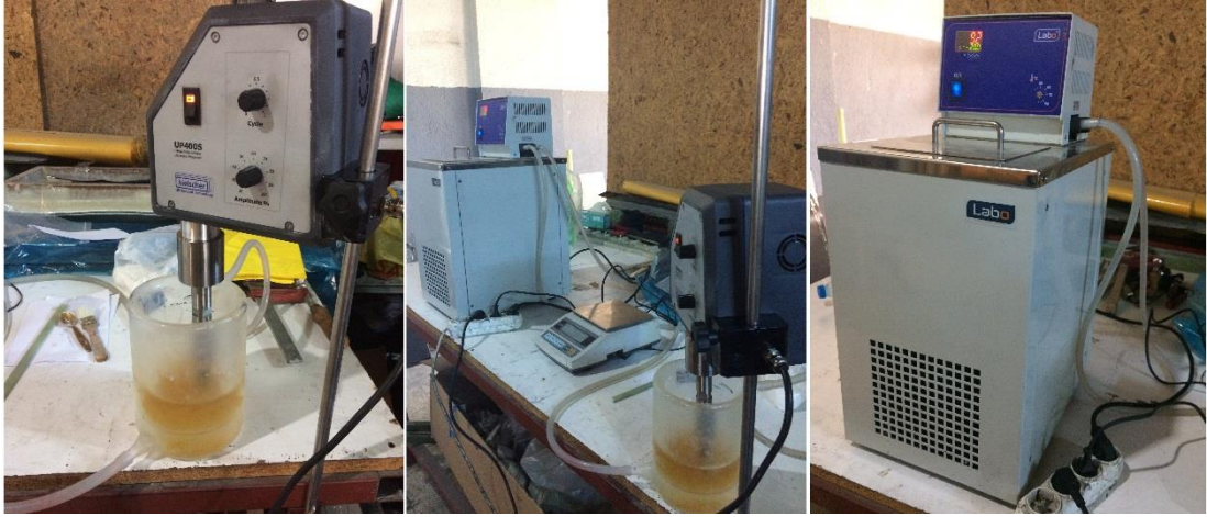
Şekil 3.2: Hielscher UP400S Ultrasonik Karıştırıcı ve Labo CH750 Soğutucu
