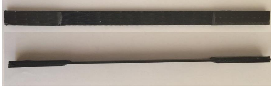
Şekil 3.7: Çekme testi için hazır numune örneği
