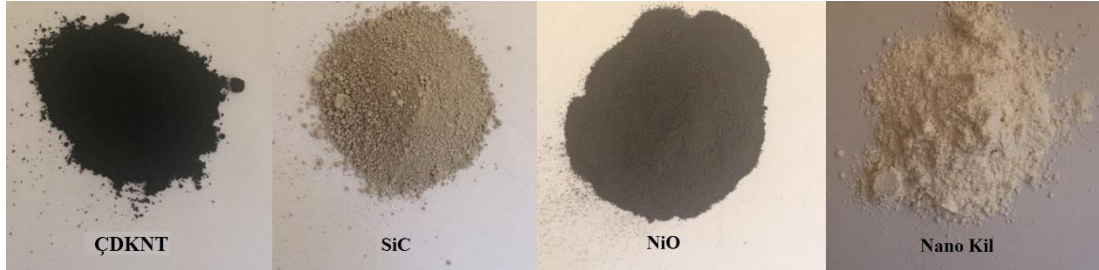
Şekil 3.3: Kompozit plaka üretiminde kullanılan nano partiküller (ÇDKNT, SiC, NiO, Nano Kil)
