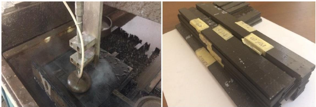
Şekil 3.6: Su jeti ile kompozit plaka kesimi ve deney numunelerinin sınıflandırılması
