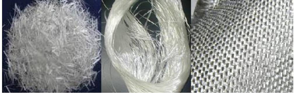
Şekil 2.2: Cam elyafı örnekleri (Cam Elyaf San. A.Ş., 2009)
