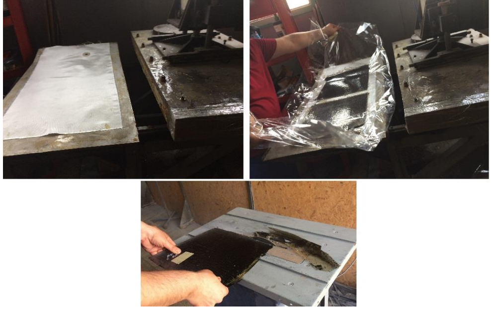
Şekil 3.5: Sıcak presleme ve çapak temizleme işlemi
