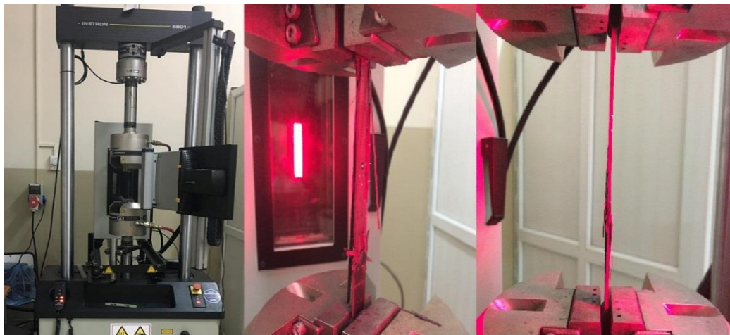
Şekil 3.8: INSTRON 8801 servo hidrolik test cihazı ve örnek test numuneleri
