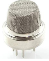
Şekil 3.9: Hava kalitesi ölçüm sensörü MQ – 135
