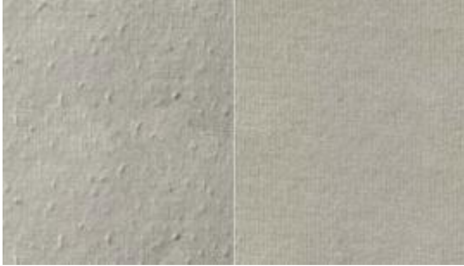
Şekil 3.1: Tekstil yüzeylerindeki pilling (boncuklanma) a) boncuklanma olmayan kumaş, b) boncuklanma oluşmuş kumaş (Web 3)
