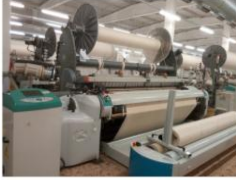
Şekil 6.2: Test numunelerinin üretildiği dokuma makinesi
