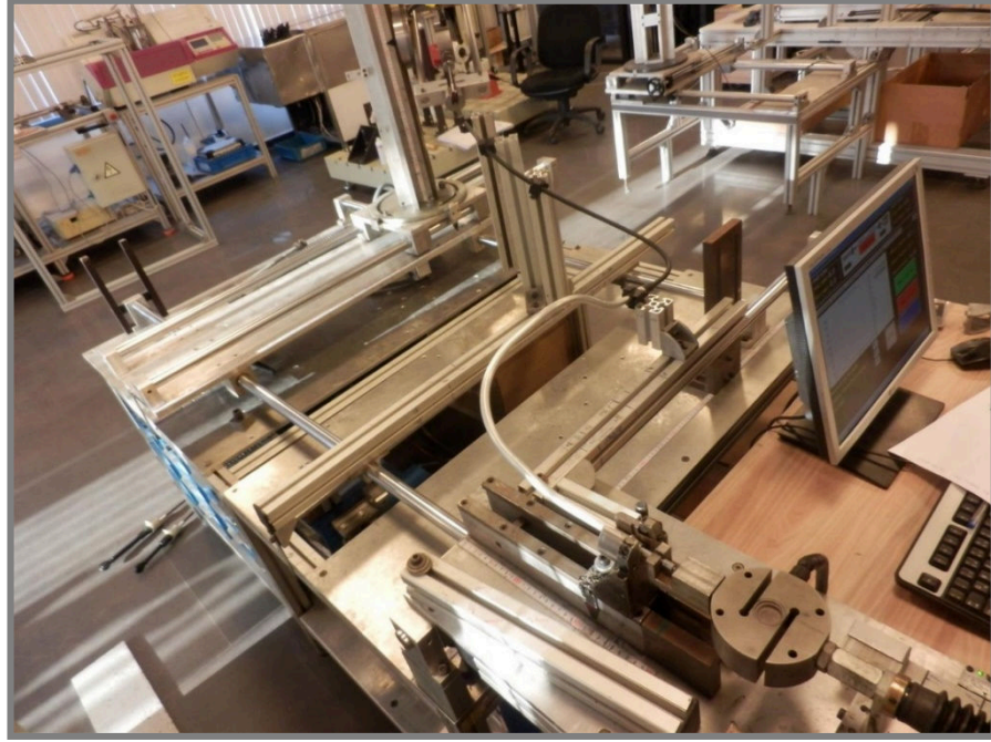
Şekil 4.3: El fren teli mekanizması verim test düzeneği
