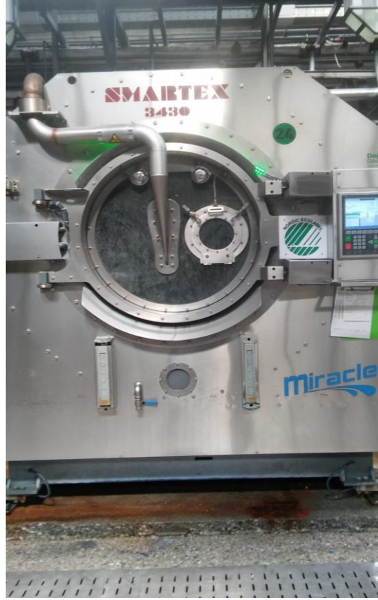
Şekil 5.2: Endüstriyel tipte denim yıkama makinası
