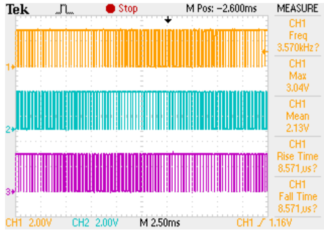
Şekil 7.6: Mikrodenetleyici ile üretilen sinüzoidal DGM sinyalleri
