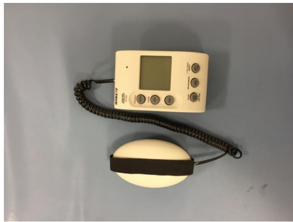
Şekil 1.1 Çalışmada kullanılan Power Track II Commander dinamometresi.
