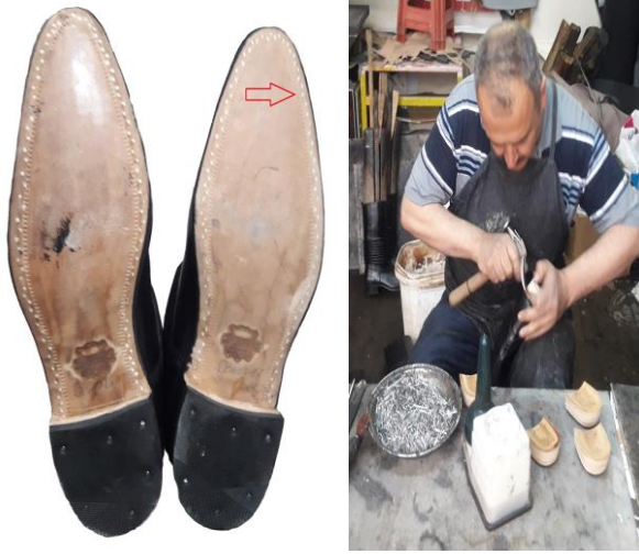
Figür 48-49: Taban Ahşap Çivileri ve Ökçe Uygulaması (Ahmet Erun Arşivi, Denizli, 2018)
