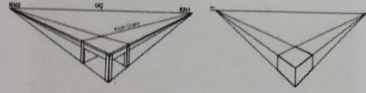
(Görsel 5) İki noktalı perspektifte göre masa ve dikdörtgen prizma çizimi. (Taşören, Ö. B. Diğerleri, 2017, [Resim], s.162)
