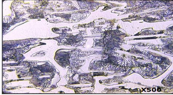
Şekil 3.2: Beyaz dökme demir mikro yapısı [30]
