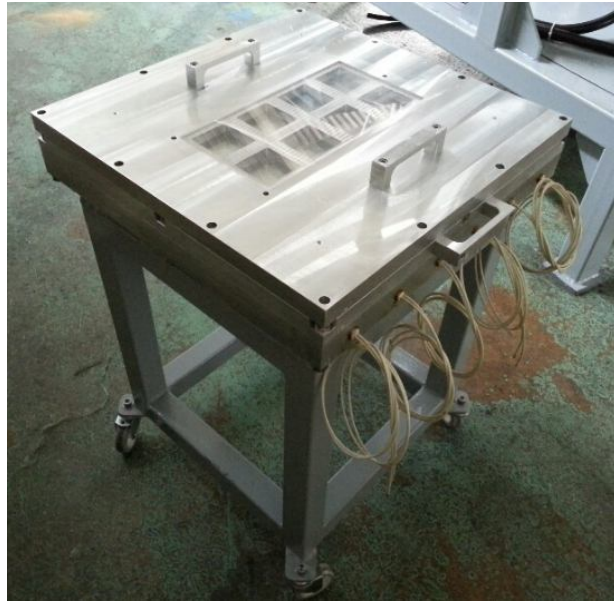
Şekil 3.54: RTM Sistemi Şase-Kalıp ve Isıtma Grubu
