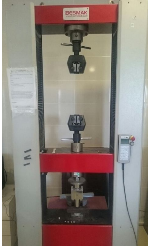
Şekil 3.72: Besmak eğme çekme basma test cihazı
