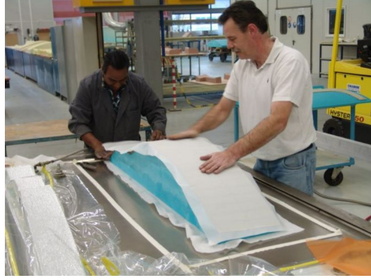
Şekil 2.17: Prepreg elle yatırma yöntemi (Aeroworks 2010)
