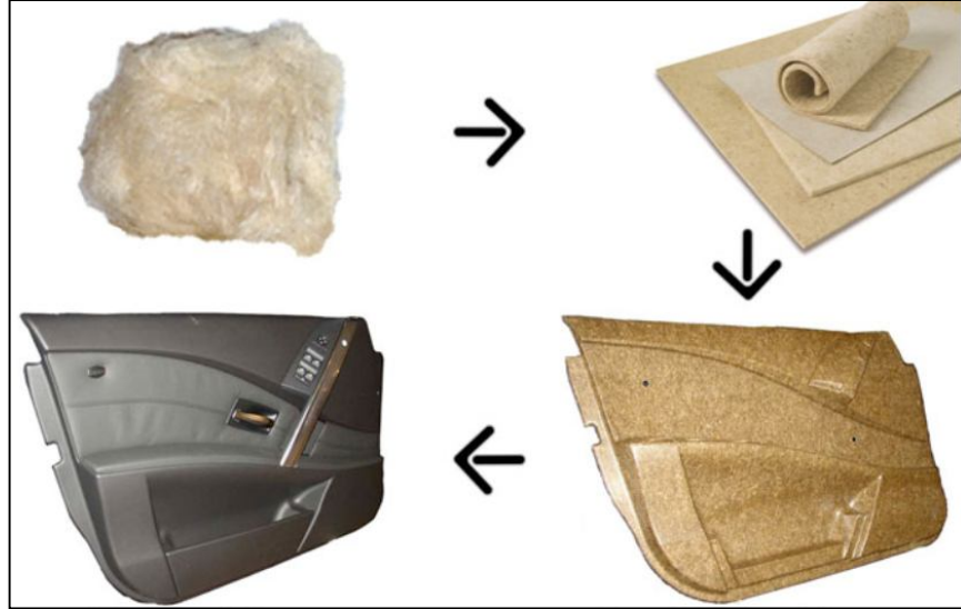
Şekil 2.2: Kapı panelinde kullanılan doğal fiber kompozit
