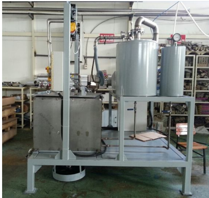
Şekil 3.40: Doğal fiber üretim sistemi
