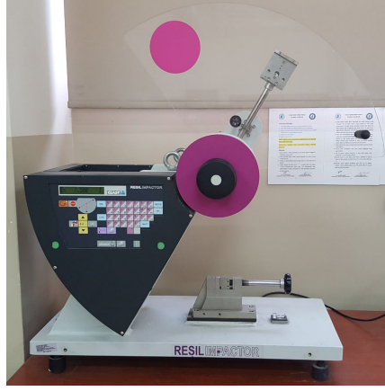
Őekil 3.64: Deneylerde kullanılan Izod darbe cihazı
