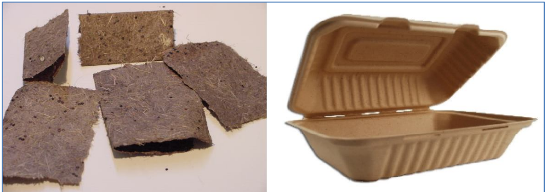
Şekil 2.377: Kalıplanmış doğal fiberler (Bravo 2016)
