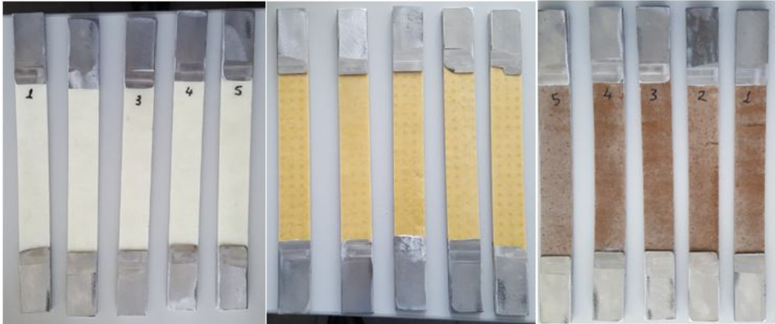
Şekil 3.61: Çekme testi numuneleri
