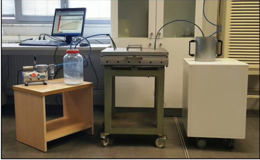
Şekil 3.55: Reçine transfer kalıplama sistemi
