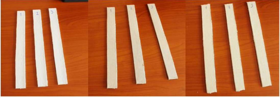
Şekil 3.62: Reçinesiz çekme numuneleri
