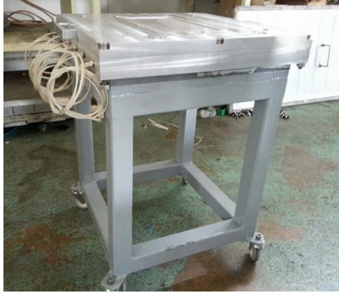
Şekil 3.52: RTM Sistemi Ayak Montajı
