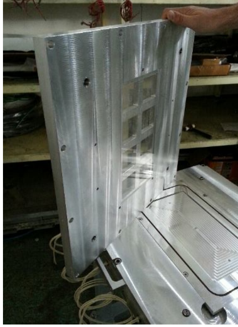
Şekil 3.53 :RTM Sistemi Üst Kalıbı
