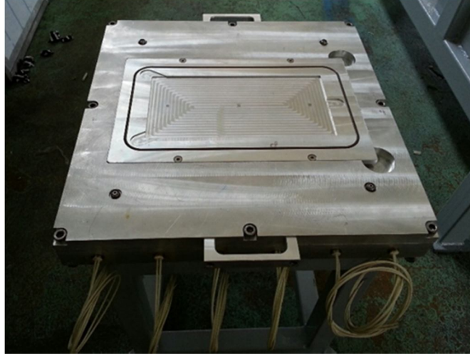
Şekil 3.51: RTM Sistemi Kalıp Alt Kısmı
