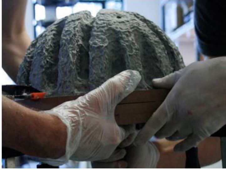
Şekil 2.38: Kalıpta form verilmiş doğal fiber malzemeden kask (Suciu 2013)
