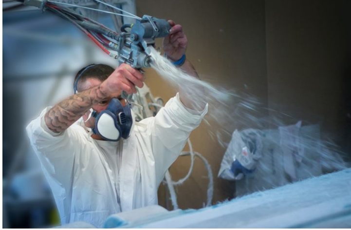
Şekil 2.19: Püskürtme yöntemi (Lamplas 2018)
