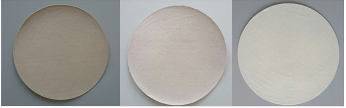
Şekil 3.39: Kayın, palmye, okaliptus fiber numuneleri
