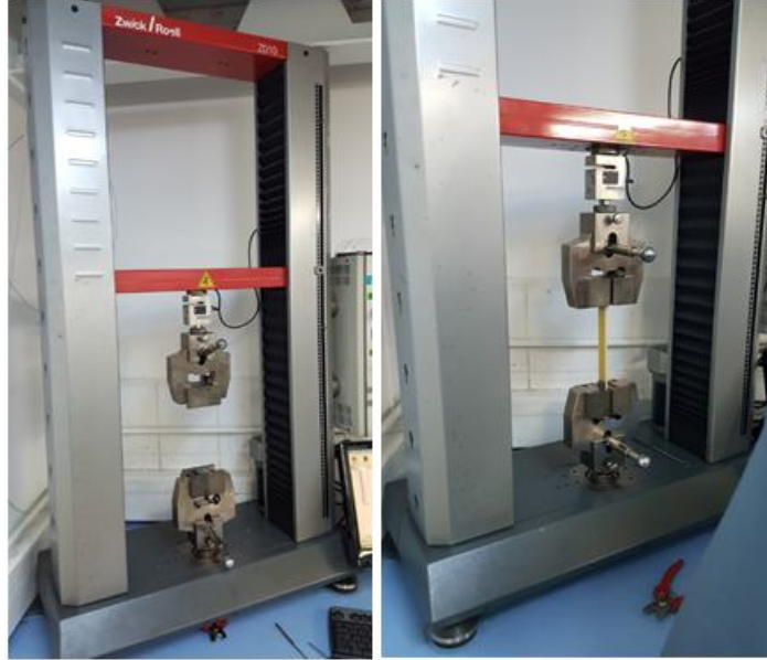
Şekil 3.63: Çekme testi cihazı
