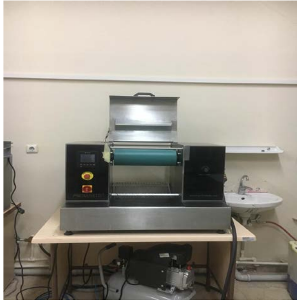
Şekil 5.1: Yatay pnömatik emdirme makinesi (Fulard)
