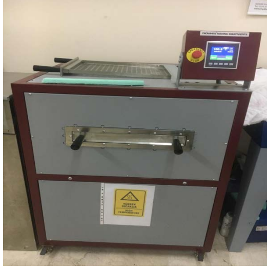
Şekil 5.2: Laboratuvar tipi ramöz
