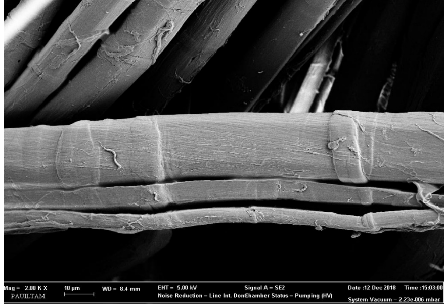
Şekil 6.10: Çinko oksit nano (80-200 nm) (%5) ile işlem görmüş keten kumaşın SEM görüntüsü
