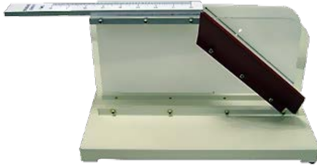
Şekil 5.5: Sabit açılı eğilme ölçeri
