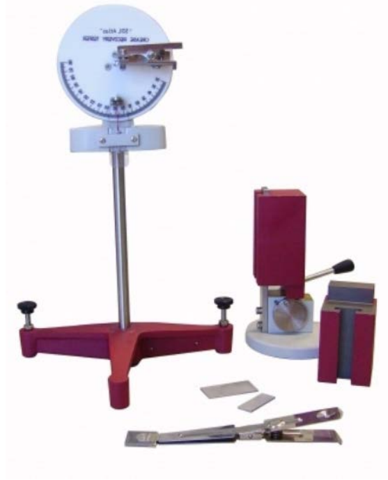
Şekil 5.3: Buruşmazlık açısı ölçümü aleti
