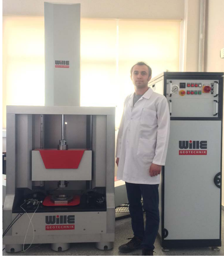
Şekil 1: Tekrarlı basit kesme deney düzeneği
