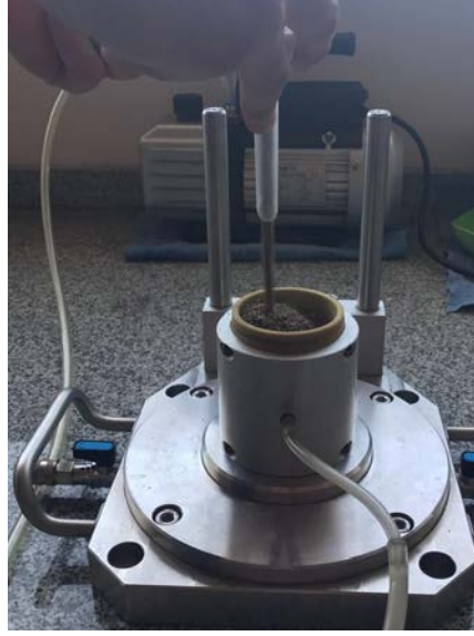
Şekil 7: Kuru yağmurlama tekniğiyle huni yardımıyla kumun numune hazırlama kalıbına yerleştirilmesi
