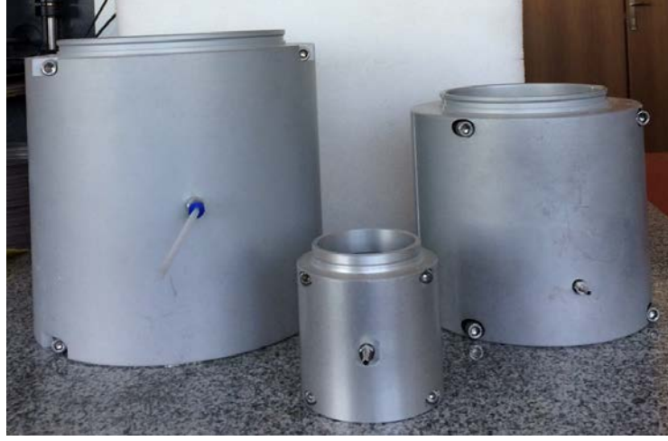
Şekil 12: Numune Hazırlama ve Yassı Bilezik Sabitleme Hücresi
