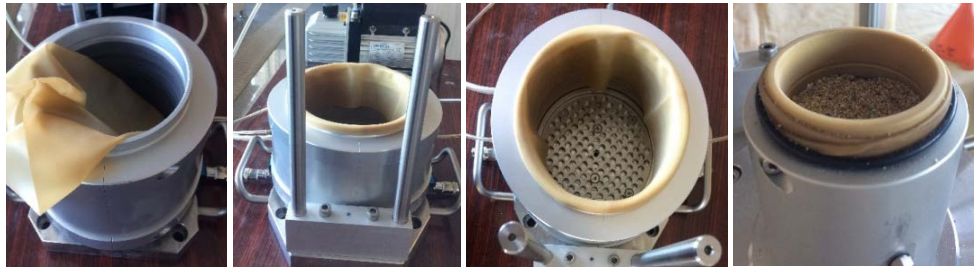
Şekil 4: Kum numunesi hazırlama aparatı örneği
