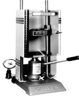
Resim 2.2: Eriyik preslenmiş membranlar oluşturmak için kullanılan tipik bir laboratuvar presi (Carver Inc., Wabash, IN'nin izniyle)
