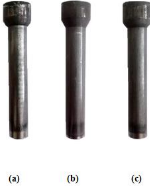
Şekil 4.10 Farklı ekstrüzyon numuneleri (a) Radyuslu ekstrüzyon numunesi (b) Açılı ekstrüzyon numunesi (c) Radyus ve açılı ekstrüzyon numunesi
