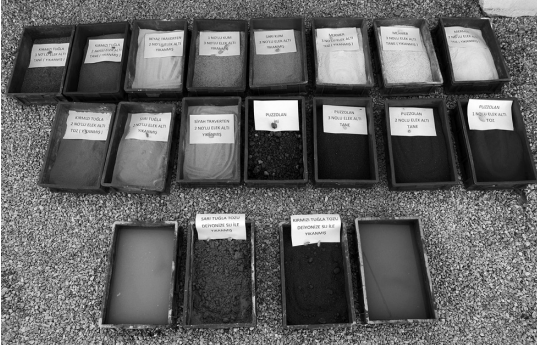
Res. 20 Harçların yapımında kullanılan değişik tıpteki kum örnekleri
