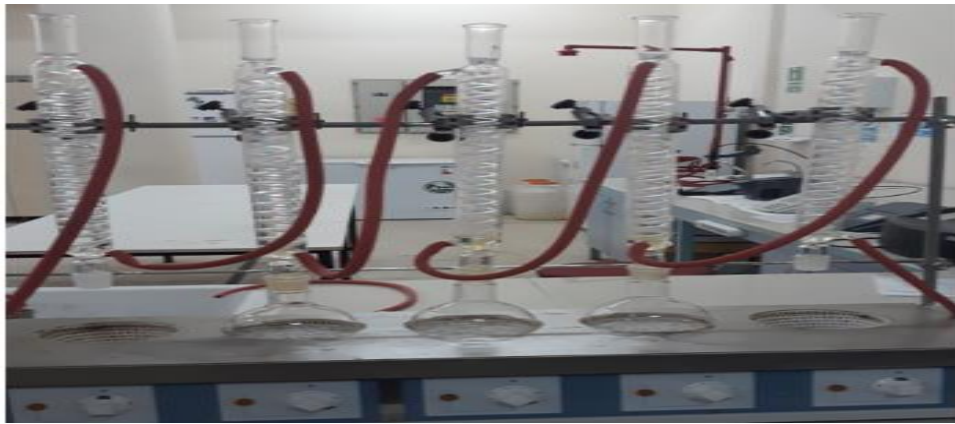
Şekil 3.2: Klinoptilolitin geri soęutucu kullanılarak NaCl ile modifiye edilmesi.
