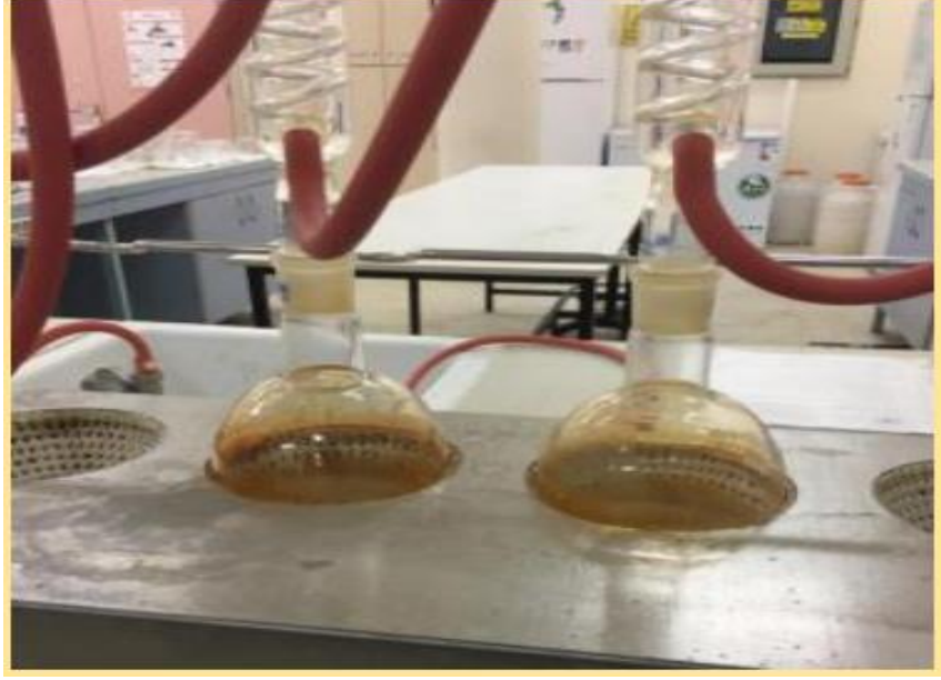
Şekil 3.3: Klinoptilolitin geri soğutucu kullanılarak \text{FeCl}_3 ile modifiye edilmesi.
