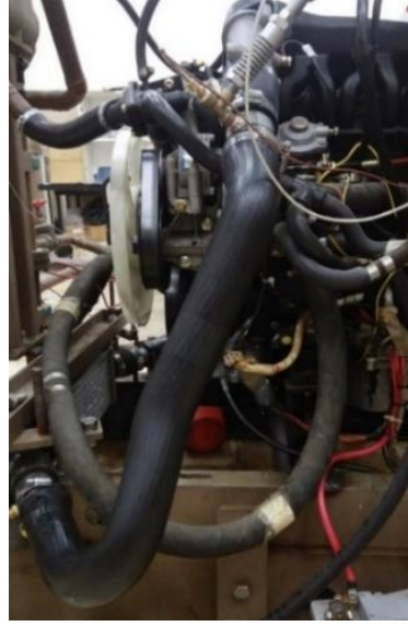
Şekil 5.1: Ara soğutucu çıkışı - emme manifoldu girişi arasındaki orijinal kauçuk esaslı boru
