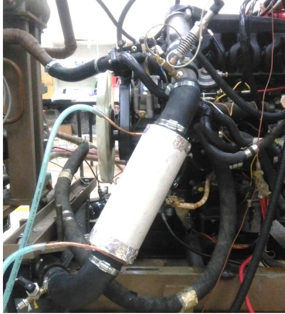
Şekil 4.11: Ara soğutucu öncesi bakır borulu ve türbülantörlü ısı değiştiricisinin montaj görünümü
