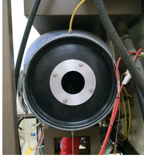
Şekil 4.17: Motor giriş havası bölgesindeki orifis plaka
