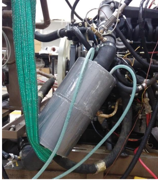
Şekil 4.16: Ara soğutucu sonrası ısı değiştiricisinin motordaki montaj görünümü
