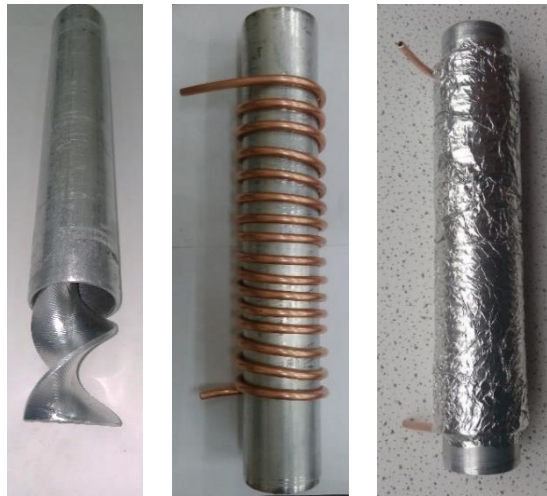
Şekil 4.10: Alüminyum düz boru üzerine bakır boru sarımı
