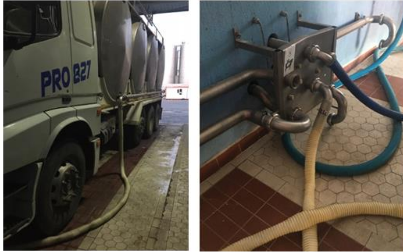
Şekil 3. 2: Flexible hortum yardımı ile süt alım işlemi
