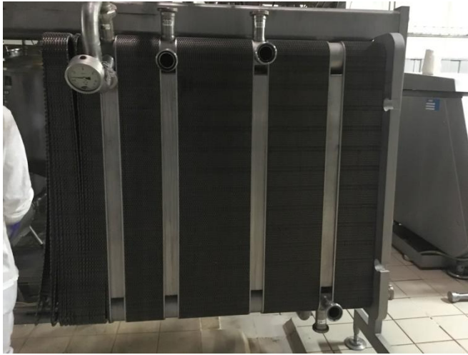
Şekil 2. 6: Bölmeli plakalı ısı değiştiricinin görünümü
