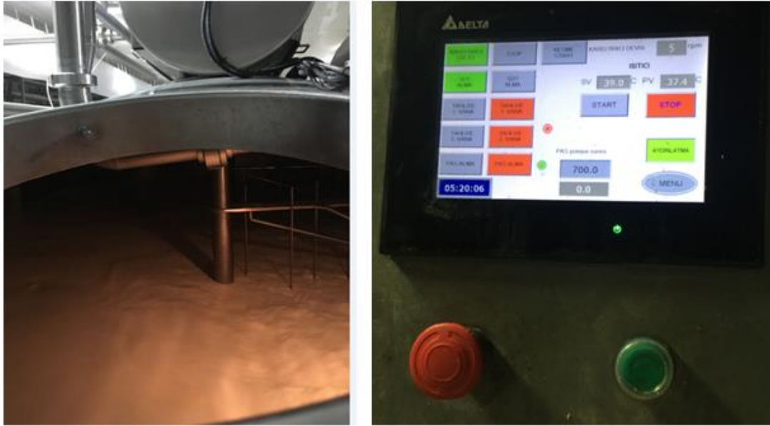
Şekil 3. 10: Eritme peyniri proses tankı içi ve kontrol paneli
