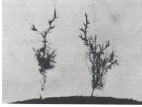
Şekil 4.3: Harici PD elektriksel ağaçlanma örneği (Hvidsten ve diğ. 2005)
