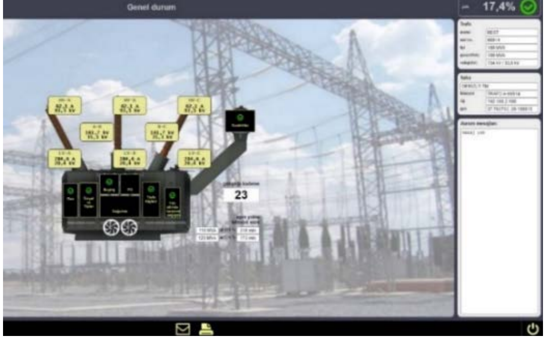
Şekil 3.9: Uzaktan izleme sistemi ana sayfa görüntüsü
