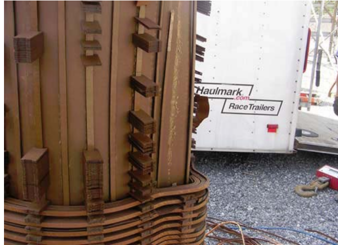
Şekil 2.10: Radyal kuvvet sonucu dışa doğru bombeleşen sargı (Lynch ve Missouri 2011)
