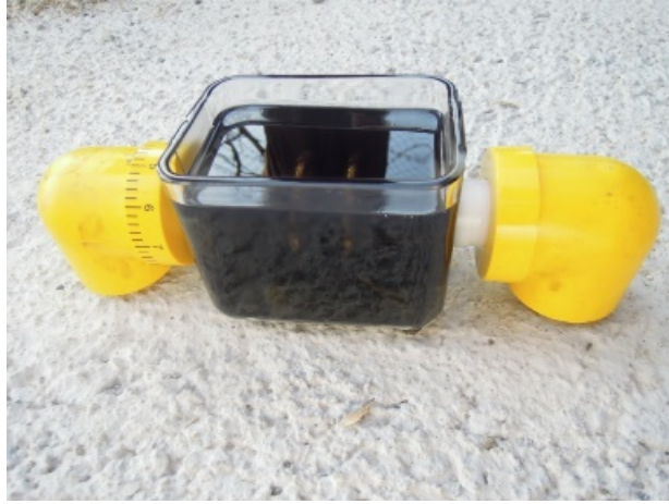
Şekil 7.15: Domlardan alınan karbonize olmuş (ark görmüş) yağ
