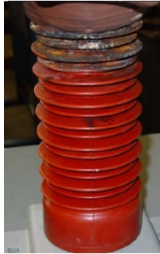
Şekil 4.9: Katı izolasyonun erime sonucu kimyasal değişimi
