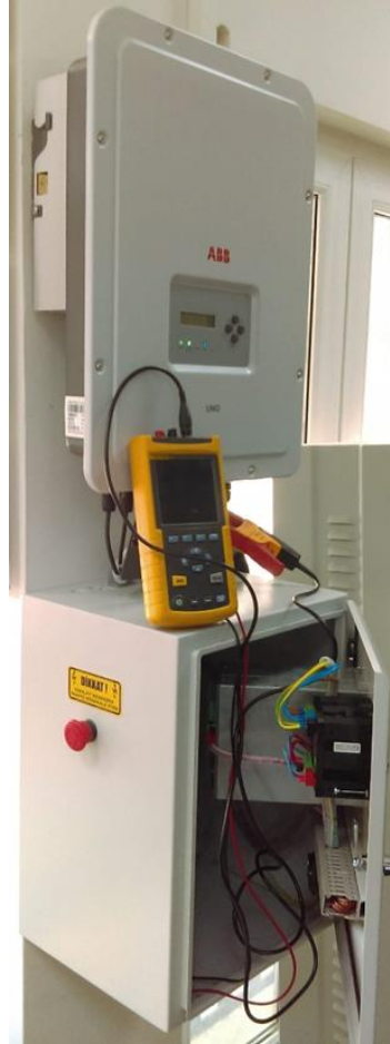
Şekil 5.16: Evirici çıkışı için güç kalitesi ölçüm düzeneği
