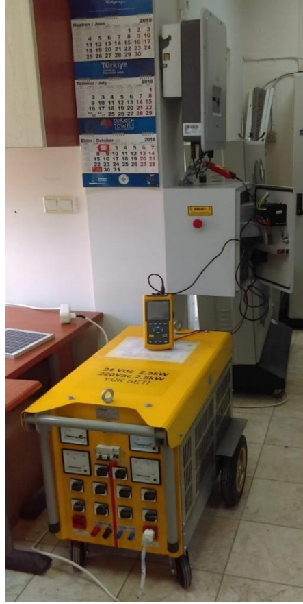
Şekil 5.20: Evirici çıkışı rezistif yük bankı test düzeneği
