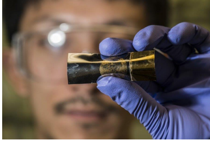
Şekil 3.4: İnce film fotovoltaik hücre (Yang ve diğ. 2014)
