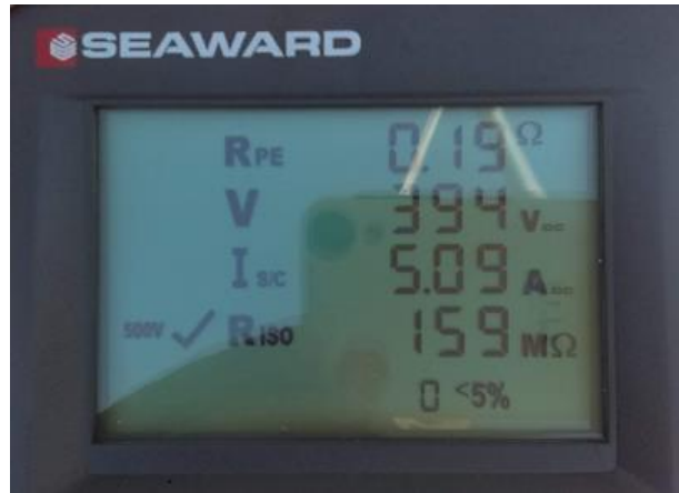
Şekil 5.9: Çerçeve toprak geçiş direnci, dizi açık devre gerilimi, kısa devre akımı ve izolasyon direnci ölçüm sonuçları
