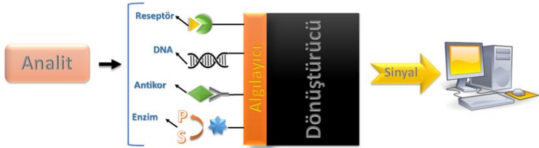
Şekil 3.1: Biyosensörün çalışma prensibi
