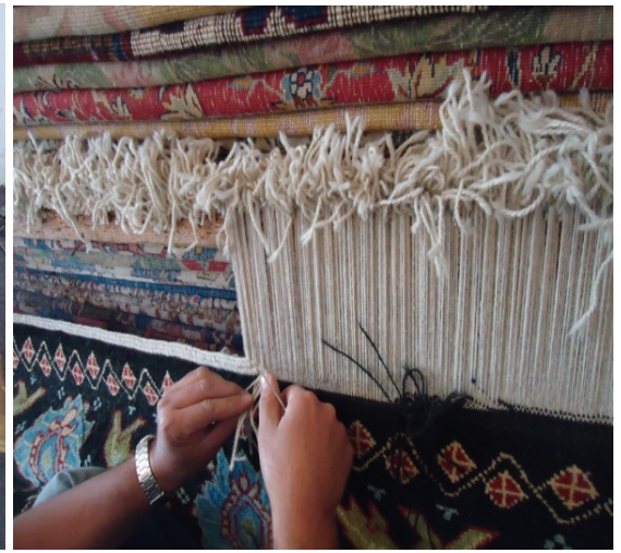
Fotoğraf 41-42: Saçak Hatası ve Onarımı
