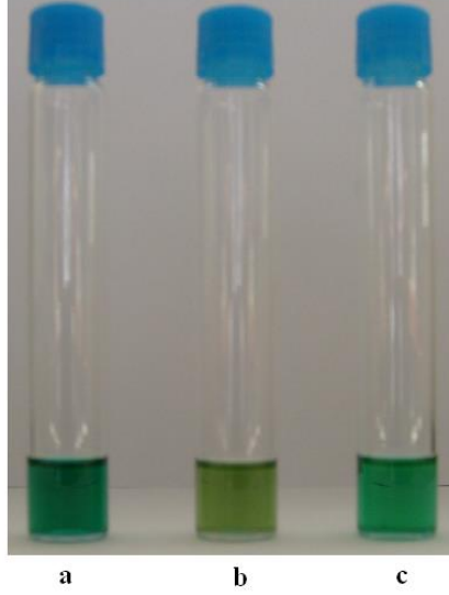
Şekil 9: Sandviç ftalosiyanın 2 bileşiğinin CO 2 sensör davranışının renk değişimi (2 (a); 2 + CO 2 (b); 2 + CO 2 çözeltisinden CO 2 uzaklaştırıldıktan sonra (c))
