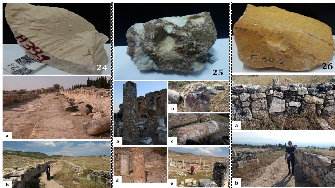
Şekil 2.14: Hierapolis 24 nolu tip doğaltaş, açık bej renkli kireçtaşı türü, Hierapolis 25 nolu tip, karışık (mix) kırmızımsı- beyaz breşik çakıltası türü, Hierapolis 26 nolu tip doğaltaş, sarımsı renkli kalkerli kumtaşı türü.
