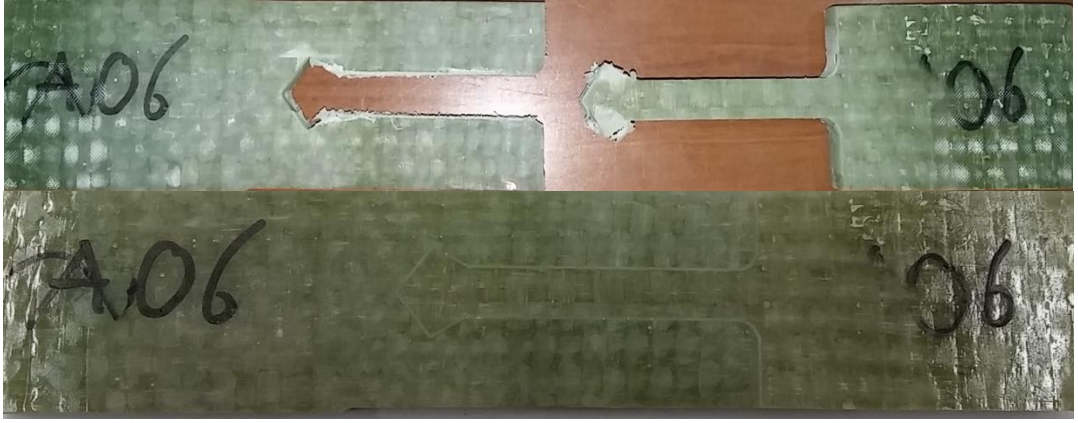
Şekil 4.22: Deneysel öncesi beşgen dil tasarımı (A06 numunesi) ve deney sonrası oluşan deformasyonlar
