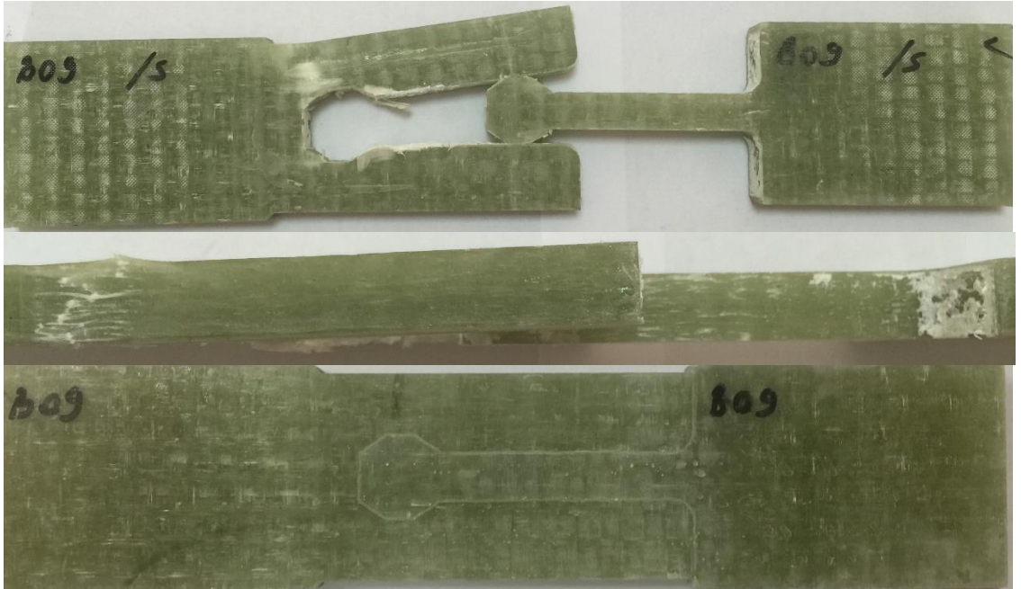
Şekil 4.43: Deney öncesi sekizgen dil tasarımı (B09 numunesi) ve deney sonrası oluşan deformasyonlar
