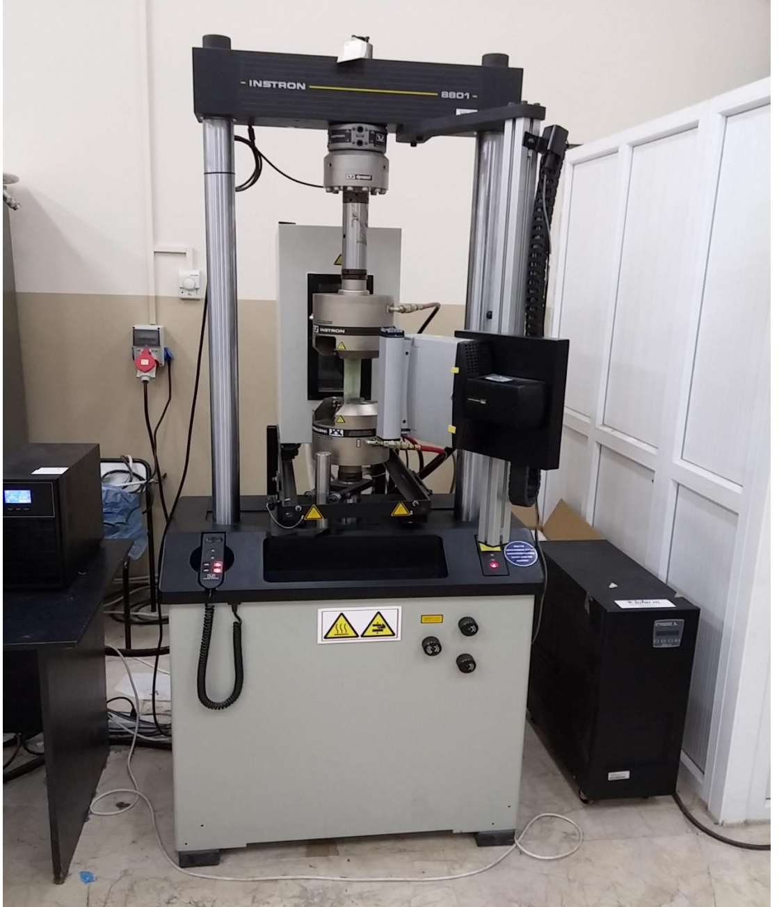
Şekil 3.5: INSTRON 8801 (100 kN) yorulma test cihazı
