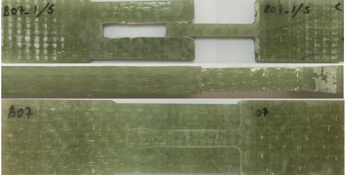
Şekil 4.41: Deney öncesi sekizgen dil tasarımı (B07 numunesi) ve deney sonrası oluşan deformasyonlar
