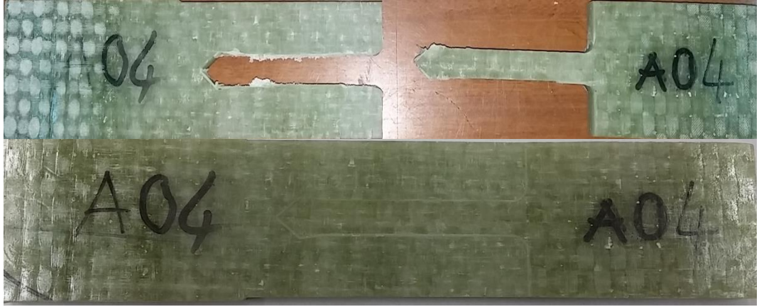
Şekil 4.20: Deney öncesi beşgen dil tasarımı (A04 numunesi) ve deney sonrası oluşan deformasyonlar
