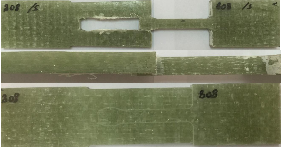
Şekil 4.42: Deney öncesi sekizgen dil tasarımı (B08 numunesi) ve deney sonrası oluşan deformasyonlar
