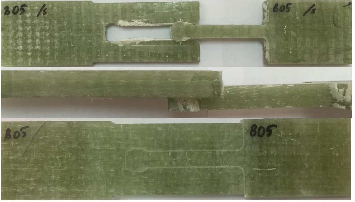
Şekil 4.38: Deney öncesi sekizgen dil tasarımı (B05 numunesi) ve deney sonrası oluşan deformasyonlar
