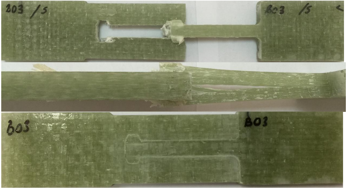
Şekil 4.35: Deney öncesi sekizgen dil tasarımı (B03 numunesi) ve deney sonrası oluşan deformasyonlar
