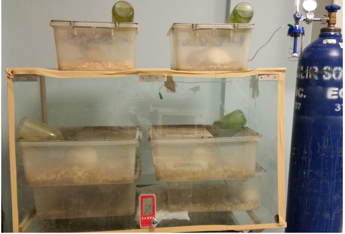
Şekil 3. Deney düzeneği. Pleksiglastan imal edilen kapalı alanda hiperoksiye maruz bırakılan deney hayvanları (altta) ve üstte oda havasında bulunan deney hayvanları görülmektedir.
