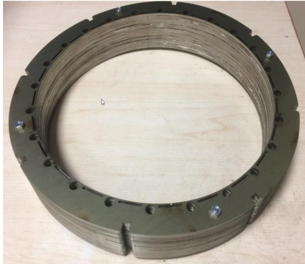
Şekil 4.18: Dış rotor saclarının paketlenmesi
