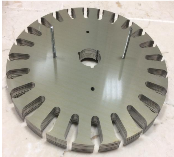
Şekil 4.12: Stator saclarının dizilmesi
