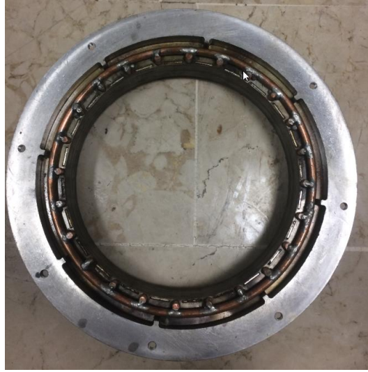
Şekil 4.20: Dış rotor imalatının tamamlanmış durumu
