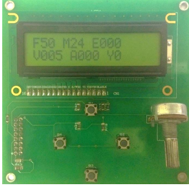
Şekil 5.12: Sürücü kullanıcı arayüzü prototipi
