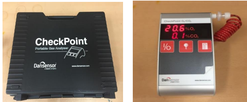
Şekil 2.9: Paket içi gaz atmosferinin belirlenmesinde kullanılan cihaz
