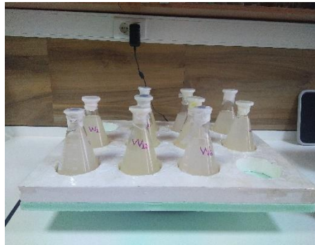
Şekil 2.11: Kapasitesini arttırmak amacıyla modifiye edilmiş çalkalayıcı
