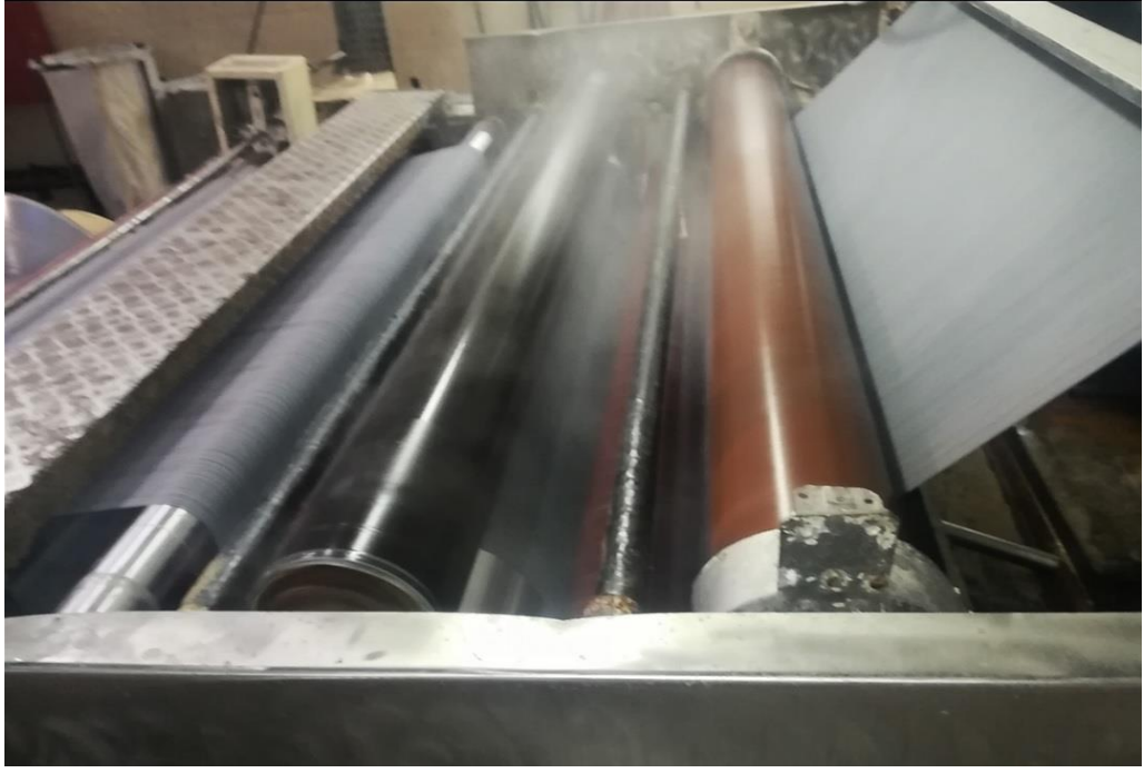
Şekil 2.5: Sevk silindirlerinden geçen çözgü ipliklerinin daldırma ve baskı silindirlerini izleyerek haşıl teknesi içerisinde geçişi (Çalışma yapılan haşıl makinesi)
