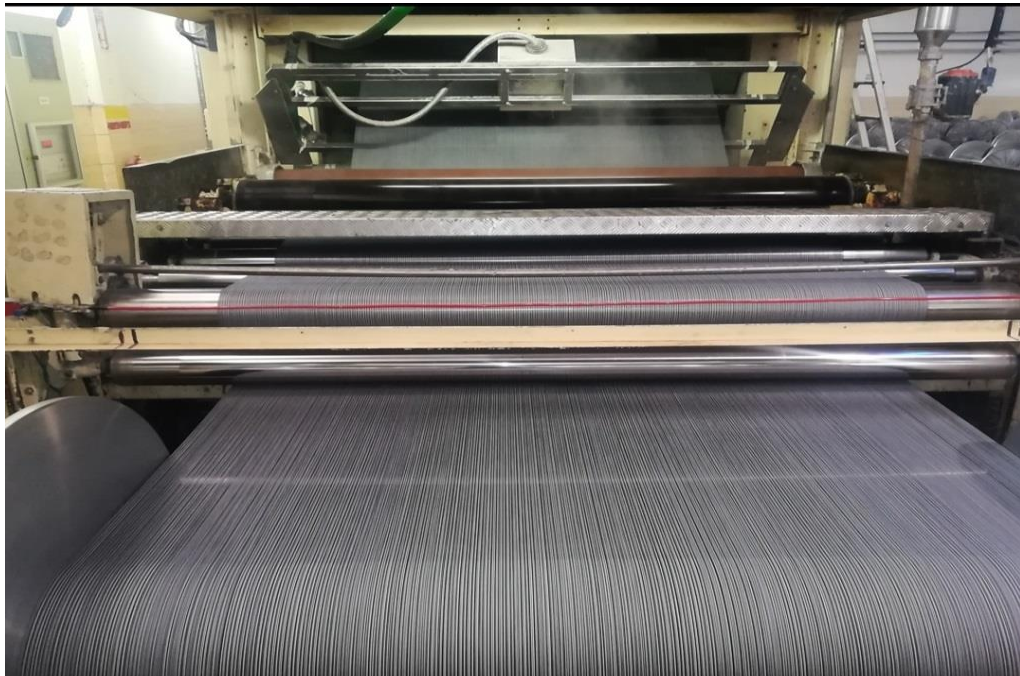
Şekil 2.4: Çözgü ipliklerinin sevk silindirinden geçerek haşıl teknesine girişi (Çalışma yapılan haşıl makinesi)
