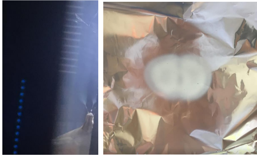
Şekil 6.1: Elektroğirme yöntemi ile nanolif üretimi (damlacıktan nanolif oluşumu)
