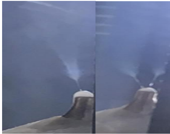
Şekil 6.2: Damlacıktan tek ve çift jet oluşumu
