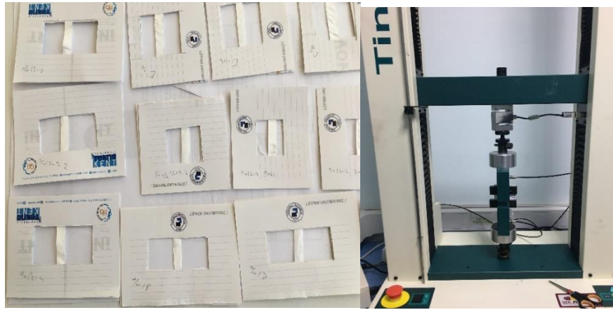
Şekil 5.49: Kopma-Uzama test numuneleri ve test cihazı
