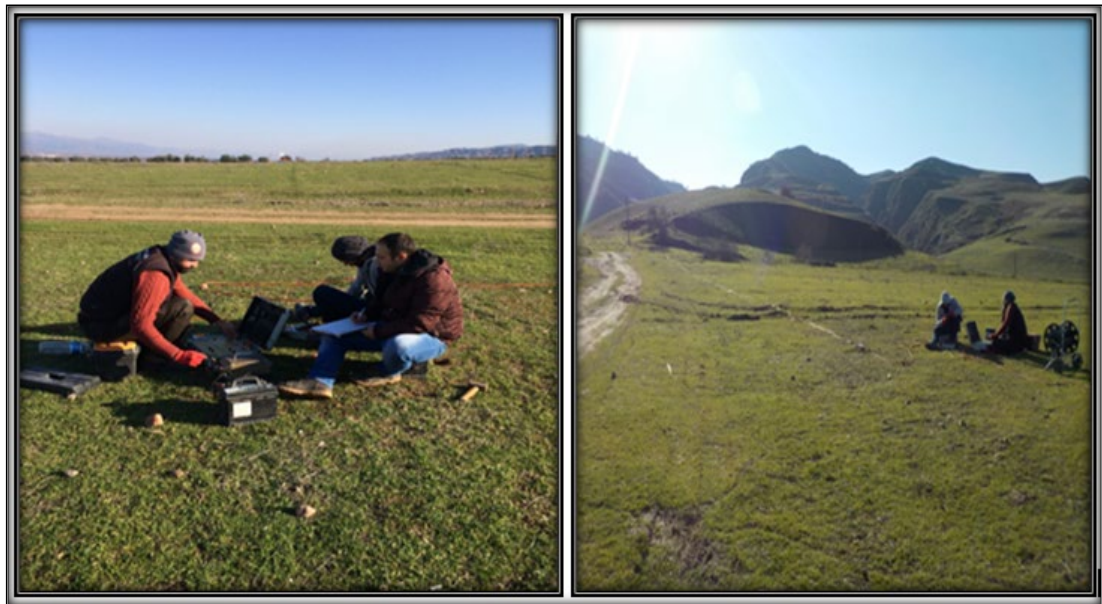
Şekil 5.4: Göbekli mahallesinde yapılan çoklu-elektrot rezistivite çalışması.
