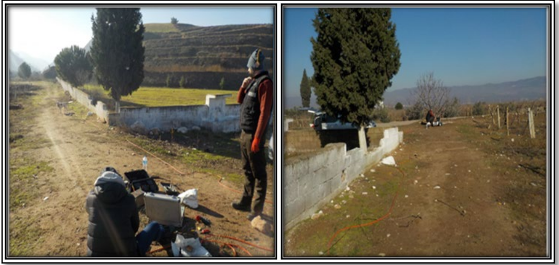
Şekil 5.2: Çoklu-elektrotlu rezistivite çalışması.
