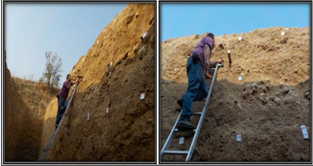
Şekil 5.17: Çelik tüple numune alma çalışması.
