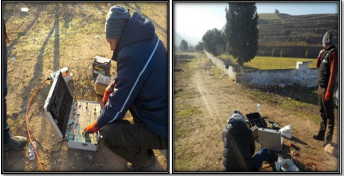
Şekil 1.3: Arazide yapılan çoklu-elektrotlu öz direnç çalışması.
