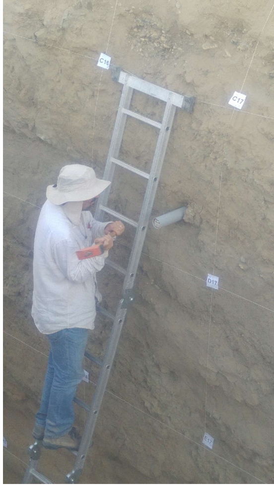
Şekil 5. 16: OSL/TL analizi için çelik ve plastik tüpler kullanılarak örnek alma.
