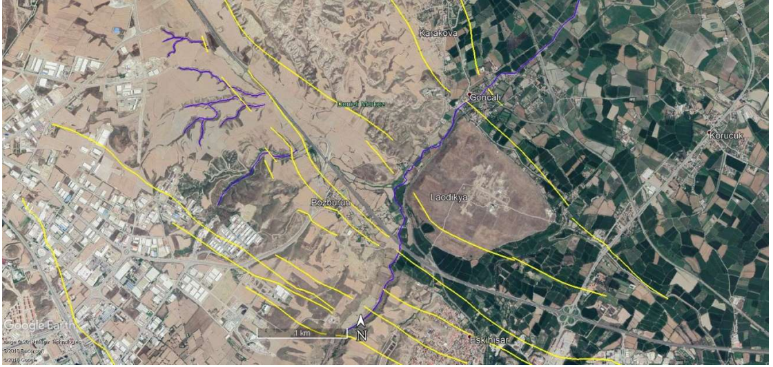
Şekil 5. 2: Bozburun mahallesinin kuzeybatısındaki dere yataklarının faylanmalarla birlikte sağ yönlü dirsek yapması.
