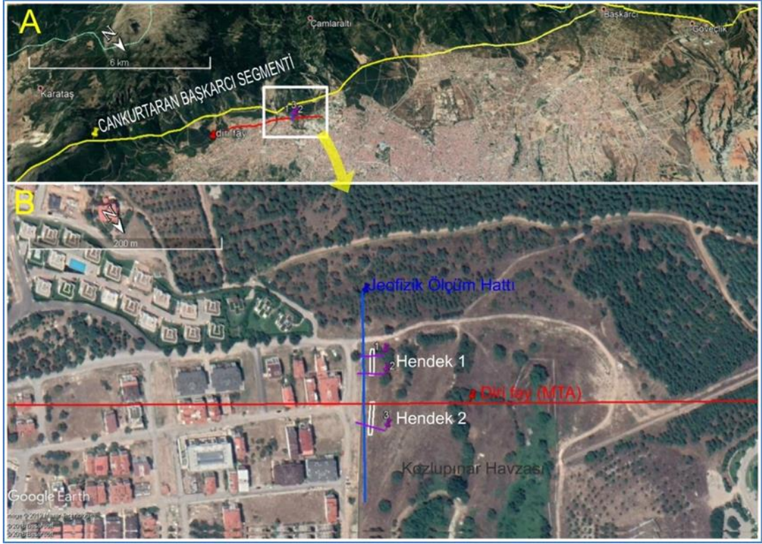
Şekil 1.3: A) Babadağ Fayı Cankurtaran Başkarcı Segmenti, B) Jeofizik ölçüm hattı ve hendek alanları (Sarı çizgi sahada jeomorfolojik ve yapısal olarak tespit edilen fayı, Kırmızı-çizgi diri fayı, mavi renkli çizgi jeofizik ölçüm hattını, mor renkler rezistivite anomalilerini ve beyaz alanlar belirlenen hendek alanlarını göstermektedir).
